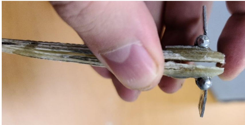
Figura 3.13 Probeta de delaminación con vista de prefalla
