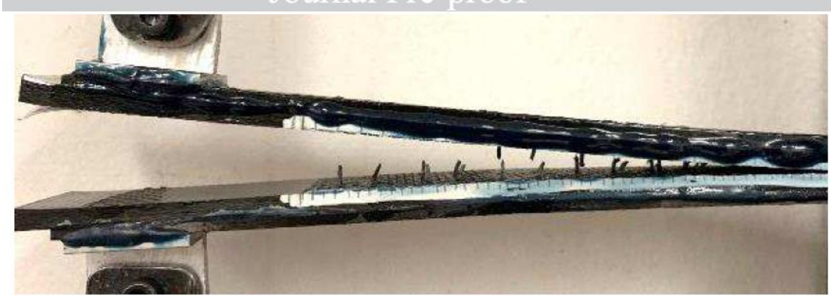
Figura 4.6 Delaminación convencional de compuesto 3D [49]
