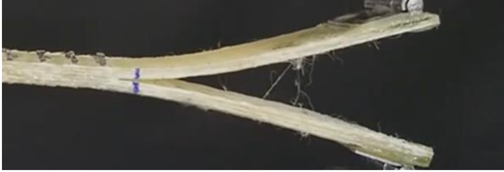
Figura 1.5 Delaminación en compósito
