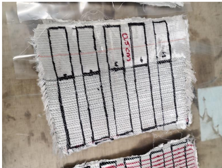
Figura 3.7 Capa protectora en probetas de delaminación
