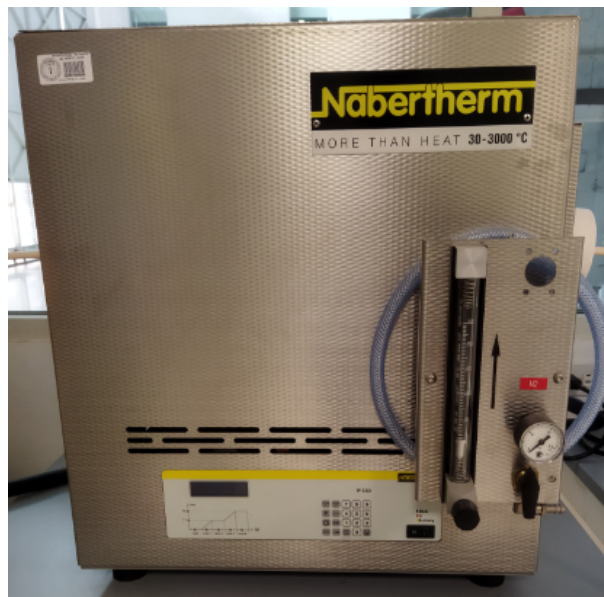
FIGURA 3.7: Horno tubular empleado para el proceso de sinterización.
