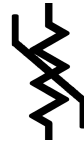
FIGURA 2.6: Sugerencia de símbolo propuesto por la norma IEEE Std 315-1975 (Ratificada en 1993) para la representación del varistor en diagramas eléctricos y electrónicos.
