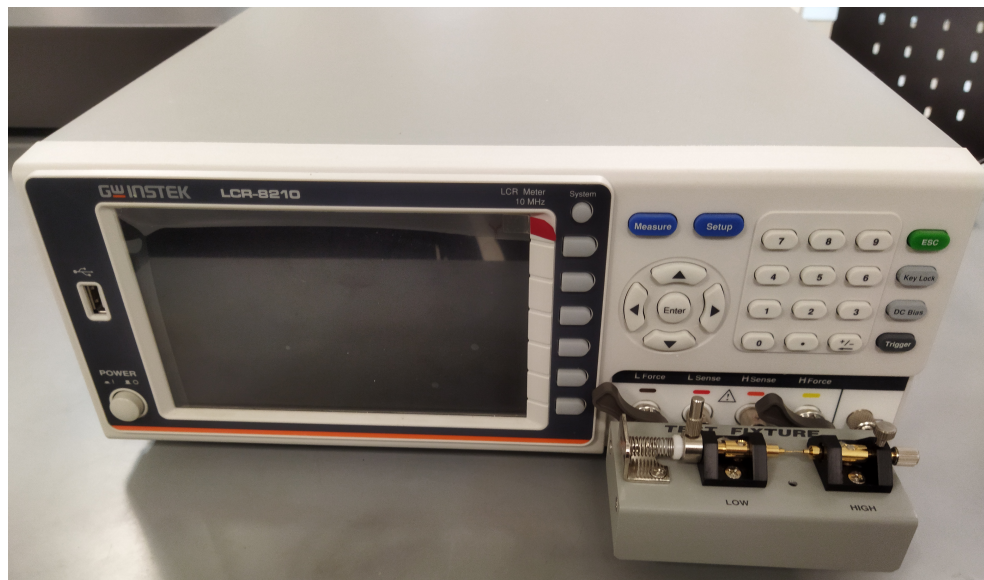
FIGURA 4.6: Probador LCR para la medición de la capacitancia C y de la conductancia ac G .
