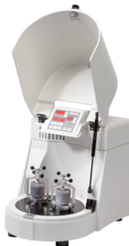
FIGURA 3.1: Micro-molino planetario de bolas usado para las mezclas.
