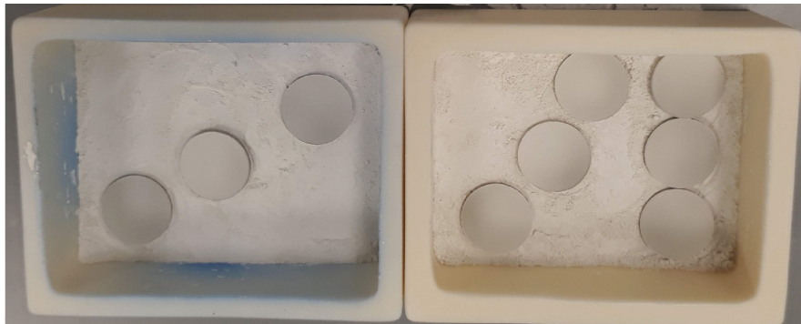
FIGURA 3.6: Muestras colocadas sobre polvo de \text{SnO}_2 dentro de un crisol de alúmina.
