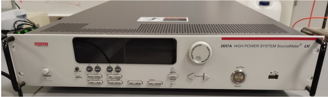
FIGURA 4.5: Equipo de medición de alta tensión empleado para la caracterización de la curva E - J de las tabletas.
