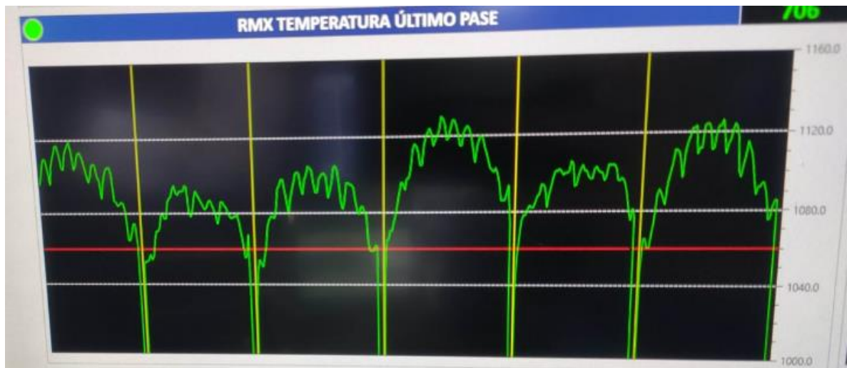
Figura 14. Gráfico de temperatura del último pase del molino reversible de 6 planchones consecutivos
