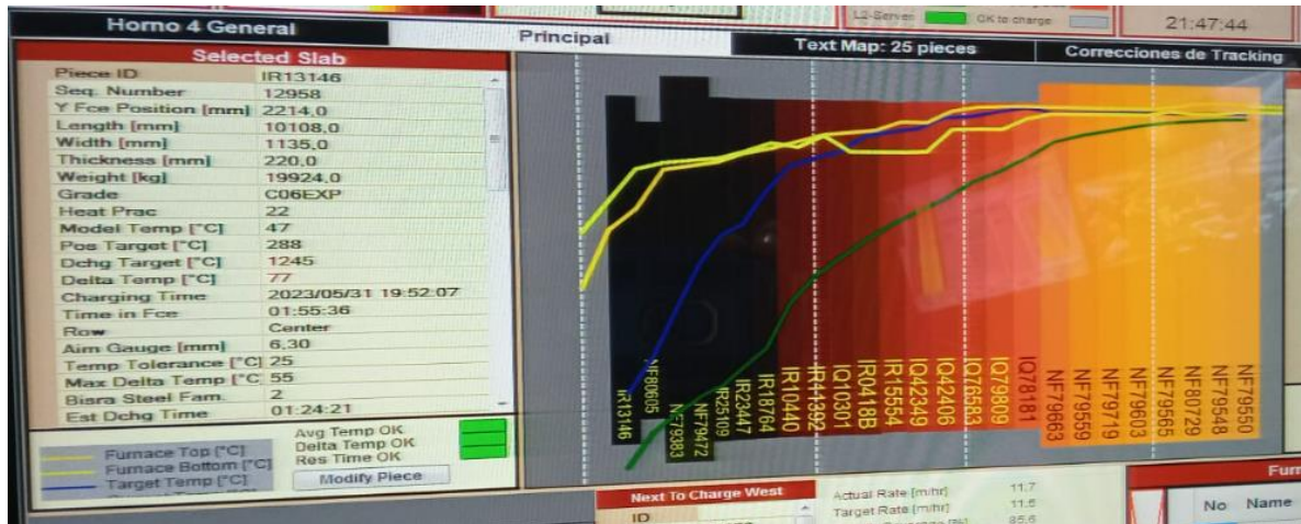
Figura 11. Modelo de calentamiento del Horno 4 del MC3 Ternium
