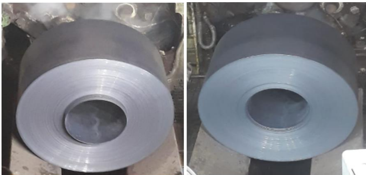
Figura 41. Izquierda: “rollo flojo”. Derecha: rollo estándar.
