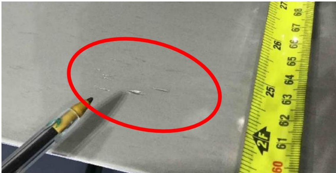
Figura 44. Marcas por fricción o fricciones.
