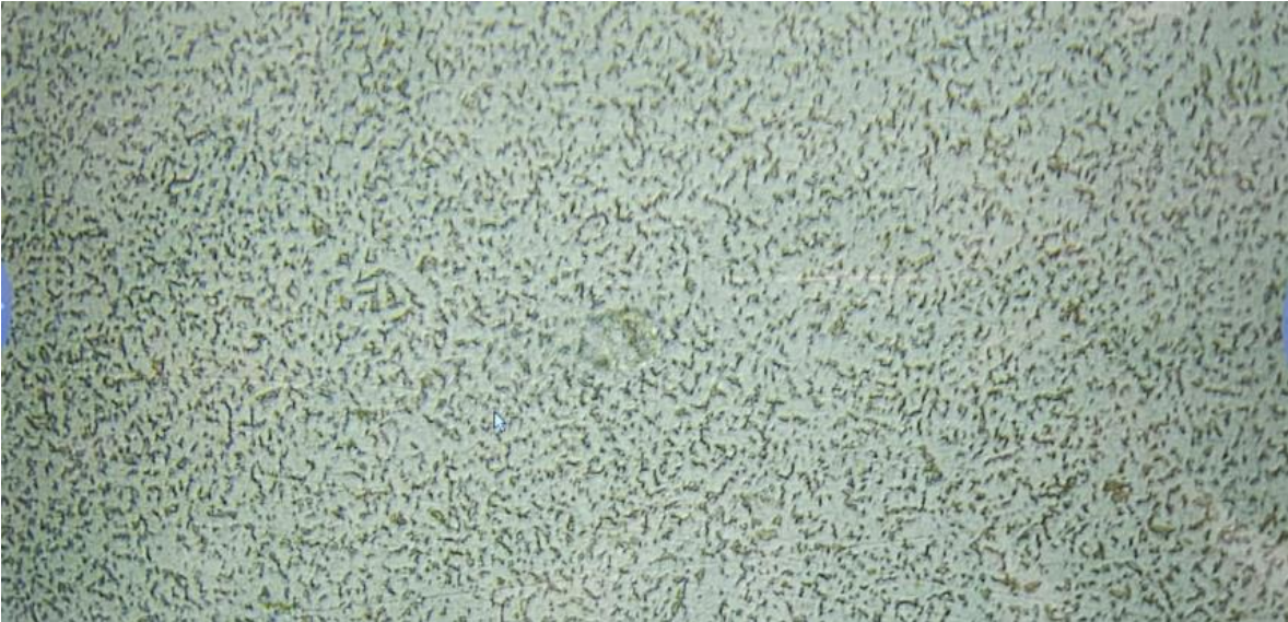
Figura 61. Metalografía con aumento de 10x con ataque de nital 3.6%.
