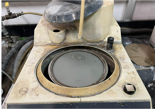
Figura 56 Equipo Struers LaboPol-1 utilizado para el proceso de pulido
