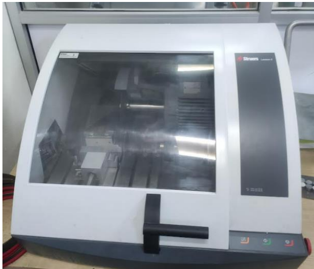
Figura 51. Cortadora de disco de carburo de silicio Struers Labotom-5
