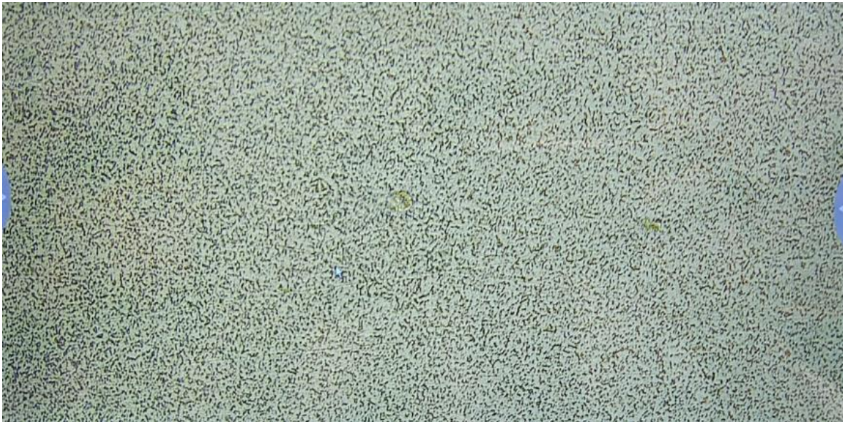
Figura 60. Metalografía con aumento de 5x con ataque de nital 3.6%.
