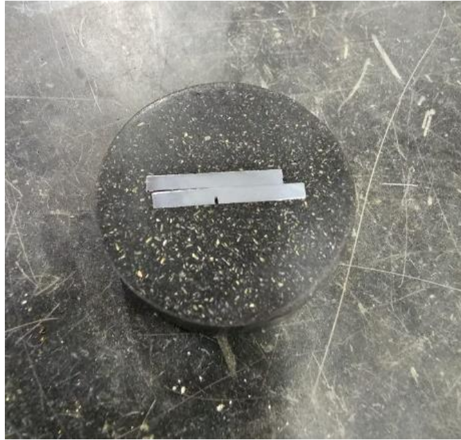
Figura 59. Muestra posterior al ataque químico con nital al 3.6%
