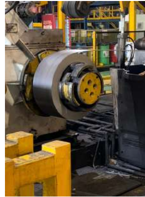
Fig. 37 Bobina de acero laminada en rieles
