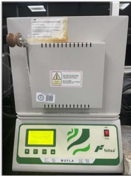
Fig. 43 Mufla, Modelo: FE-340, Serie: 1903073, Voltaje 120 V, Potencia: 1500W, Frecuencia: 60 Hz.
