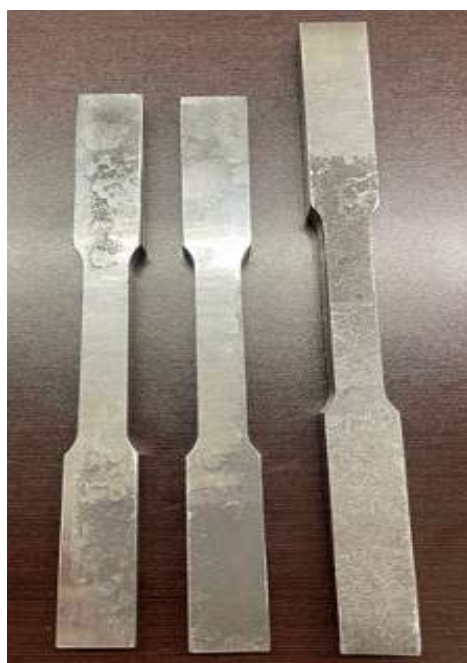
Fig. 59 Probetas en diferente condición para ensayo de tensión maquinadas
