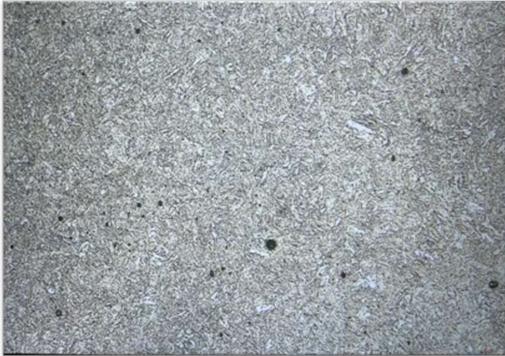
Fig. 69 Microestructura 22MnB5 condición 3 (Temple y revenido 408°C), 100x
