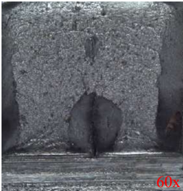
Fig. 94 Vista macroscópica de la fractura 22MnB5, -38°C, condición 3.
