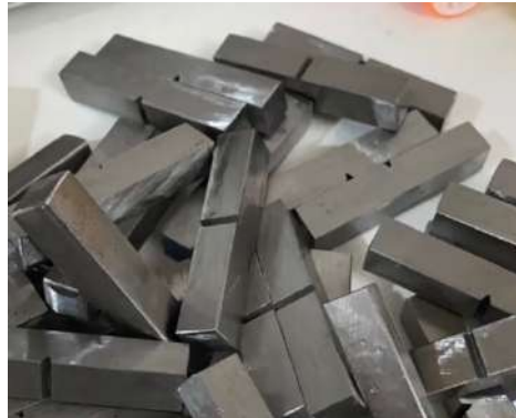
Fig. 55 Especímenes de prueba de impacto Charpy, muesca en V maquinadas.
