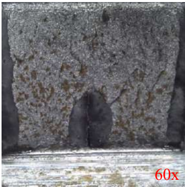
Fig. 92 Vista macroscópica de la fractura 22MnB5, -36°C, condición 3.
