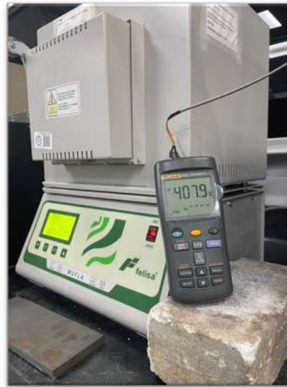
Fig. 44 Termopar tipo K utilizado para corroborar la temperatura de la mufla
