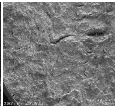
Fig. 85 Fractura frágil en la zona central 22MnB5, -22°C. SEM, condición 1.
