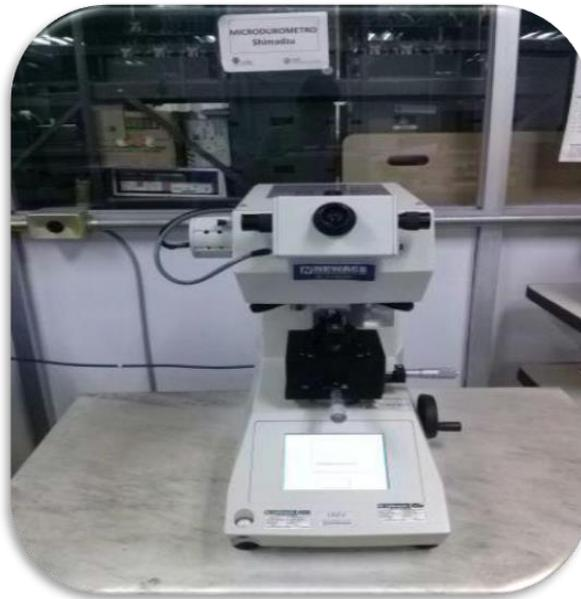
**Figura 11** Equipo utilizado para realizar el ensayo de microdureza.
