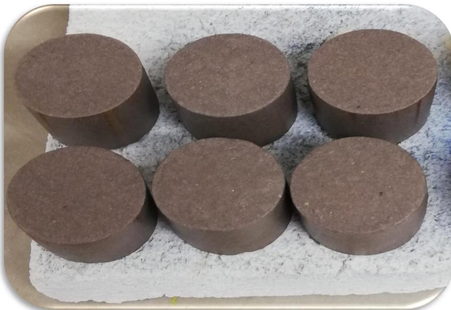
**Figura 8** Probetas sinterizadas.
