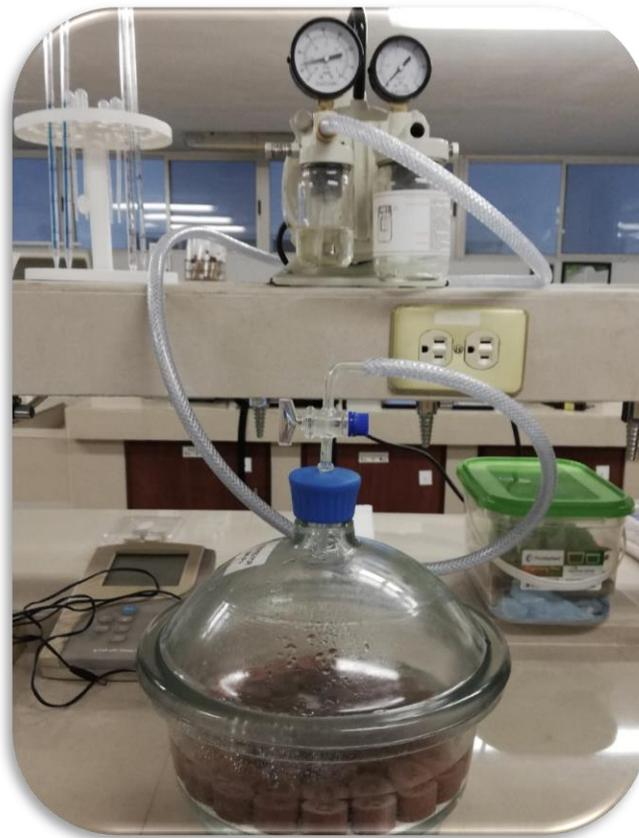
**Figura 9** Equipo utilizado para realizar la medición de propiedades físicas en las muestras cerámicas.
