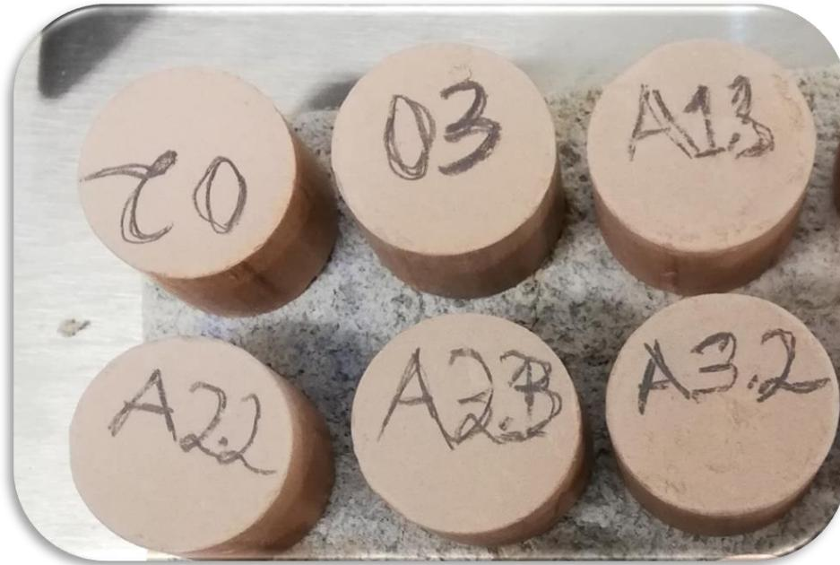
**Figura 6** Probetas experimentales obtenidas mediante el proceso de conformado uniaxial.
