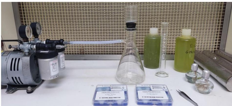
**Figura 11.** Montaje de equipo para aislamiento con uso de bomba de vacío en un ambiente aséptico.
