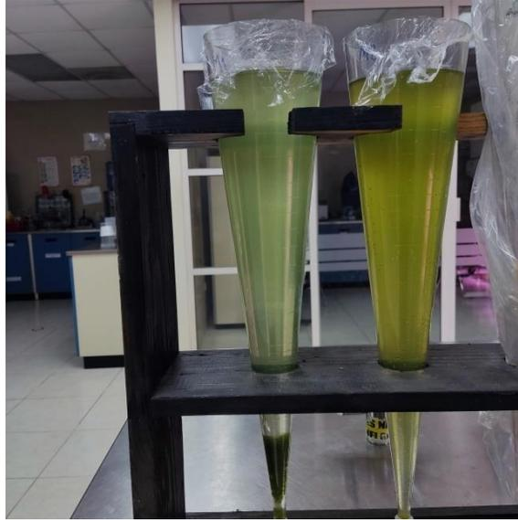
**Figura 12.** Conos de sedimentación para toma de alícuotas en la superficie de la muestra para el aislamiento de *Arthrosira* sp.
