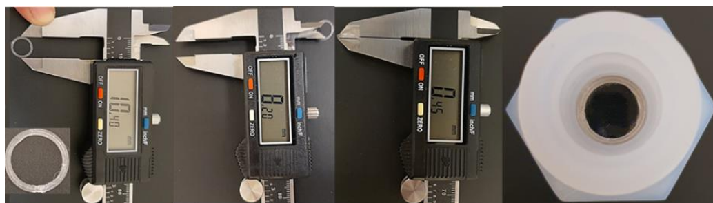
Figura 8. Molde de PETG utilizado para controlar el grosor de los hidrogeles
