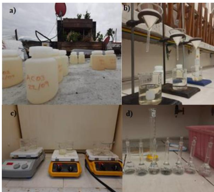
Figura 3.10. a) Toma de muestras. b) Filtrado de muestras. c) Digestión de muestras. d) Muestras listas para espectrofotómetro de absorción atómica.
