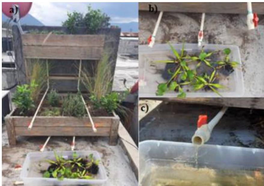
Figura 3.9. a) Prototipo de infraestructura verde completo (techo, pared y humedal). b) Prototipo de humedal. c) Agua excretada hacia el prototipo de humedal.
