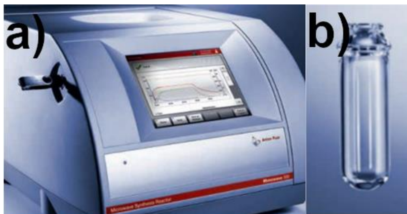
Figura V-4: Sistema Monowave 300 de Anton Paar (a) y reactor G30 (b) ( www.antonpaar.com )
