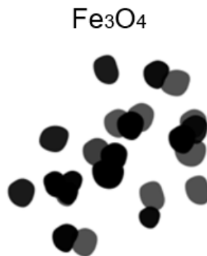
Figura V-2: Representación de las nanopartículas de magnetita obtenidas por el método de coprecipitación química
