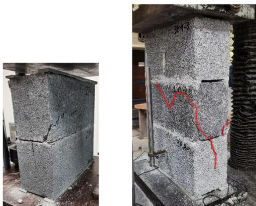
**Figura 35.** Modos de fallas en pilas con el mortero colocado en las caras laterales: a) pilas de dos hiladas, b) pilas de tres hiladas.
