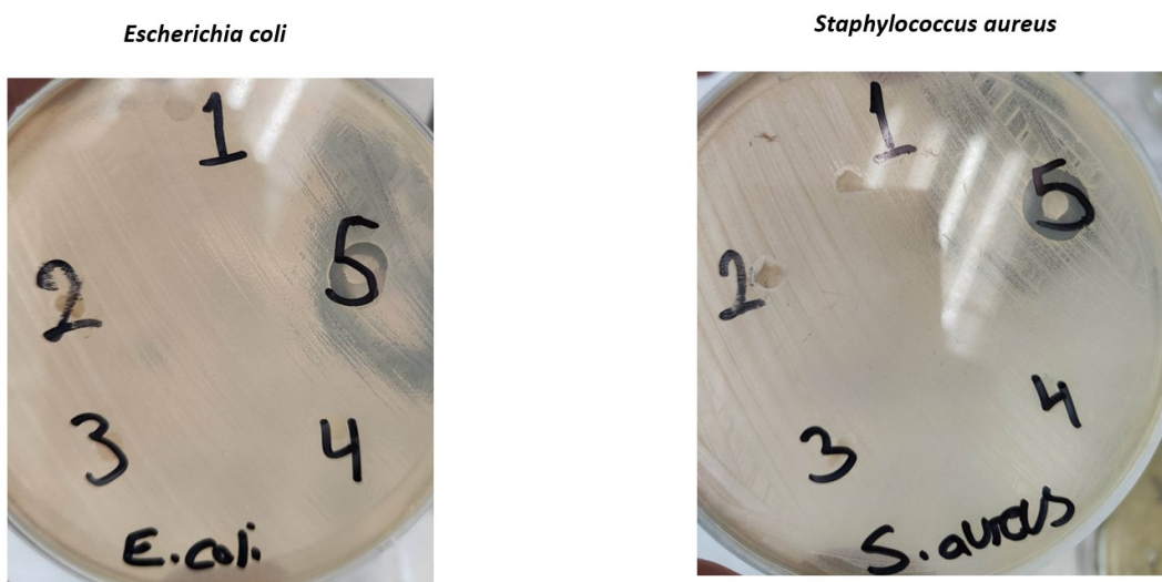
Figura 22: Actividad antimicrobiana en E. coli y S. aureus a las 24 horas en Agar Muller-Hinton para las muestras: 1. Fibra PVA/Qts, 2. Fibra PVA/Qts/HAp 10, 3. Fibra PVA/Qts/HAp 15, 4. Fibra PVA/Qts/AgHAp 10 y 5. Fibra PVA/Qts/AgHAp 15 embebida en la solución PVA/Qts/AgHAp 15.
