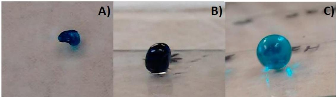
Figura 16. Efecto de la concentración del polímero sobre la encapsulación: a) capsulas deformadas (10% p/p); b) capsulas levemente deformadas (20% p/p); c) capsulas sin deformar (30% p/p) (Crédito de la imagen: J.H Alfaro-Álvarez).
