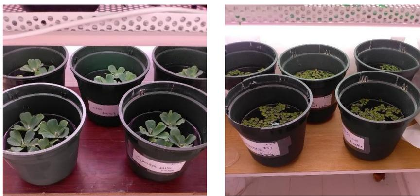
**FIG. 5: GRUPOS DE EXPERIMENTACIÓN CON Pb (300MG/L), Cd (3MG/L) Y Sb (10MG/L), A LA IZQUIERDA GRUPOS DE EXPERIMENTACIÓN CON *P. STRATIOTES*, A LA DERECHA GRUPOS DE EXPERIMENTACIÓN CON *S. AURICULATA*.**
