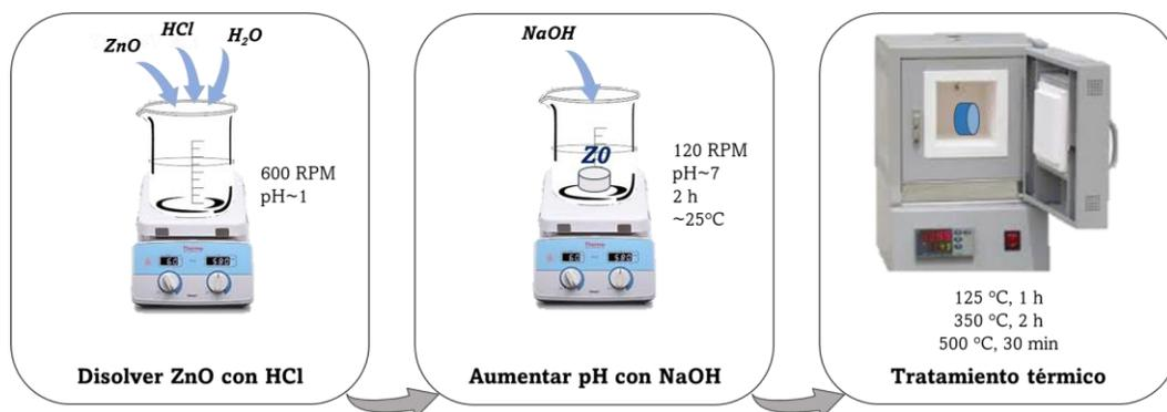
**Figura 10.** Metodología para sintetizar los recubrimientos sobre la superficie libre de zinc.
