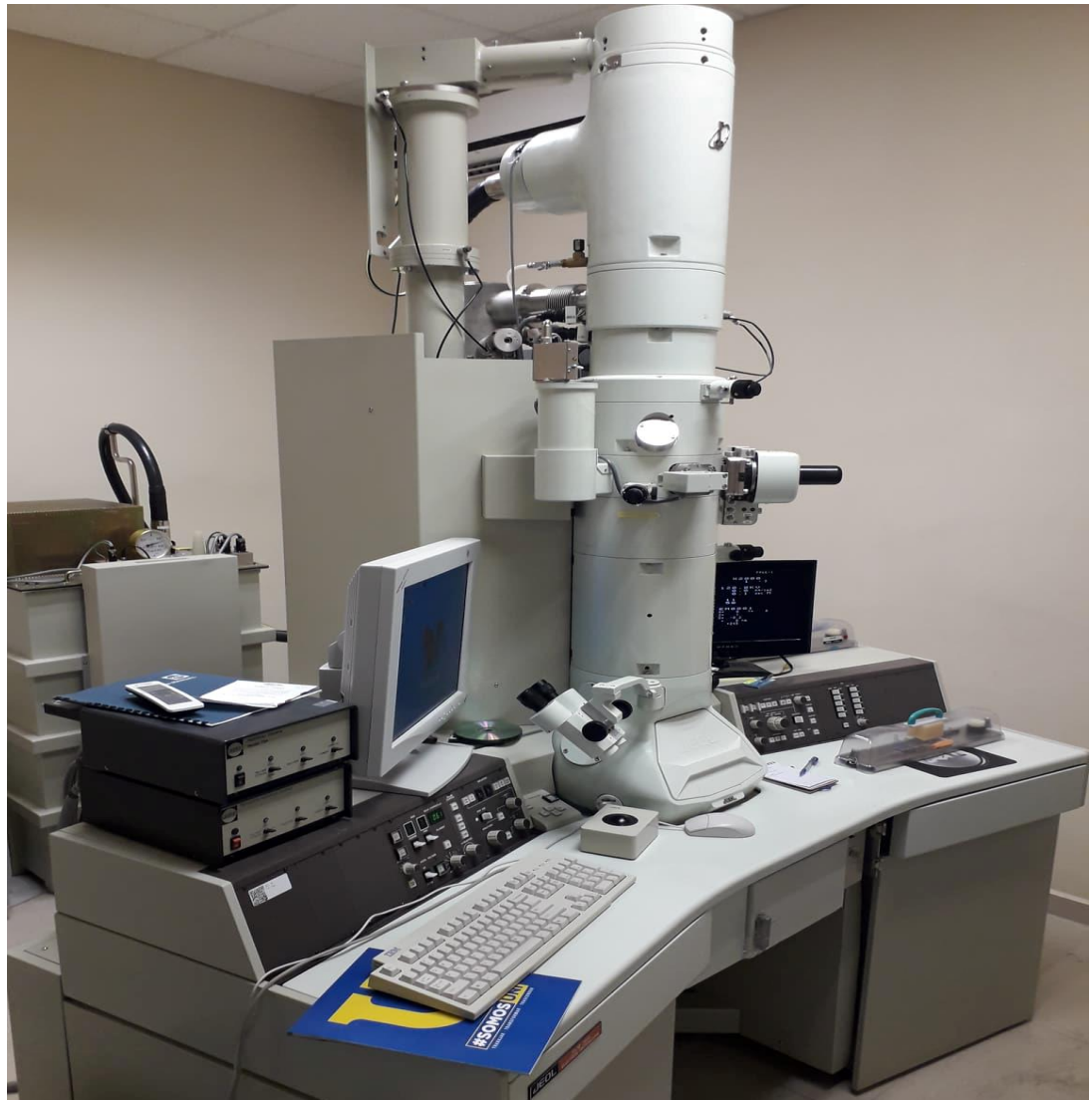
Figura 20. Imagen del equipo TEM modelo JEOL JEM-2010 utilizado.
