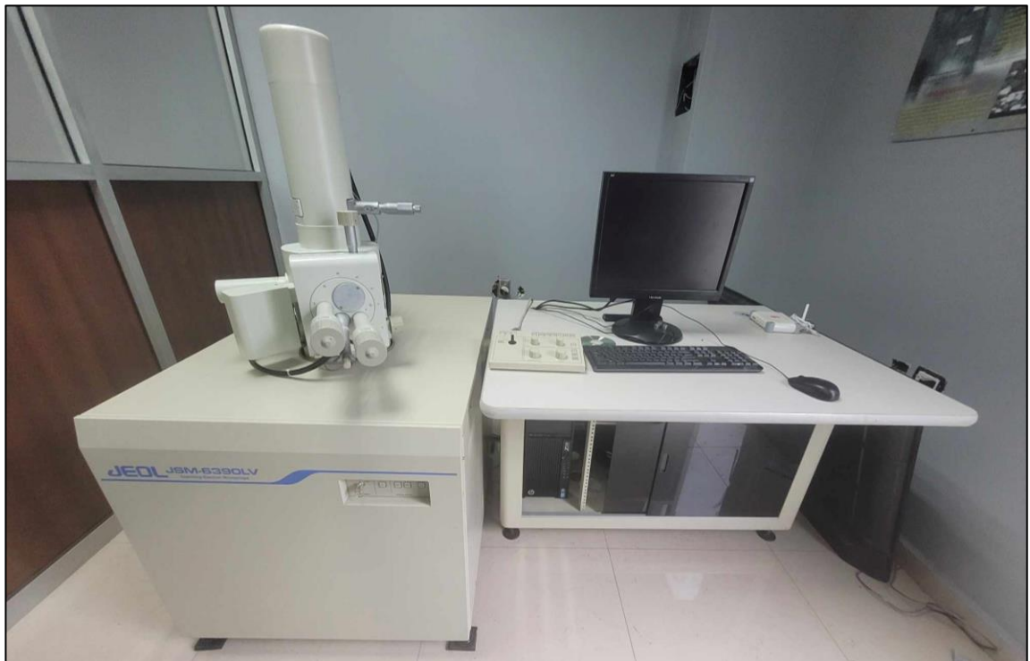
Figura 19. Imagen del equipo SEM JEOL JSM-6390LV utilizado.
