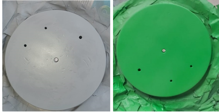
(a) Tapa frontal pintada con la base de gris primario (b) Tapa frontal pintada de color verde
