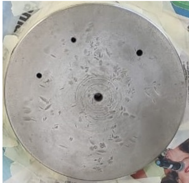
Figura B.2: Tapa frontal de la cámara a volumen constante lijada y preparada para el proceso de pintado.
