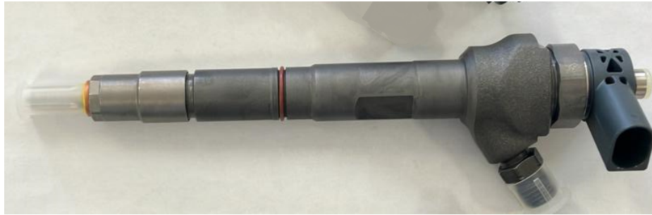
Figura 4.9: Inyector diésel tipo solenoide CRI 2.22.
