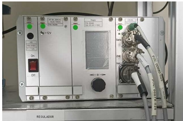
Figura 4.13: Equipo electrónico de regulación de la presión de inyección Regler.
