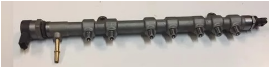
Figura 4.8: Common-rail de combustible de la marca Bosch.
