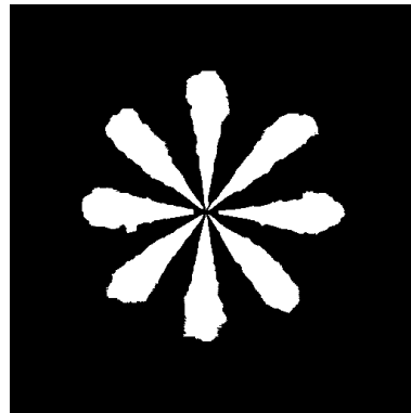
(c) Imagen del chorro binarizada
