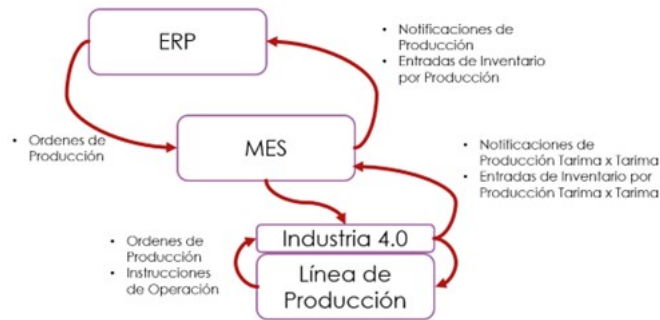
FIGURA 2.8: Diagrama de integraciones entre el ERP, MES y las líneas de producción
