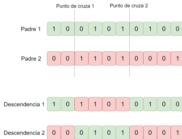
Figura 5.9: Ilustración del operador de cruce
