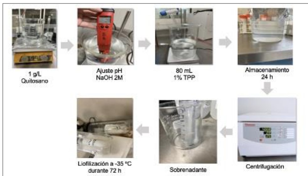
Figura 3. Procedimiento para la obtención del quitosano nanoparticulado.
