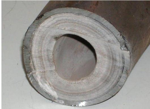
**Figura 5.** Formación de incrustaciones en una tubería (16).
