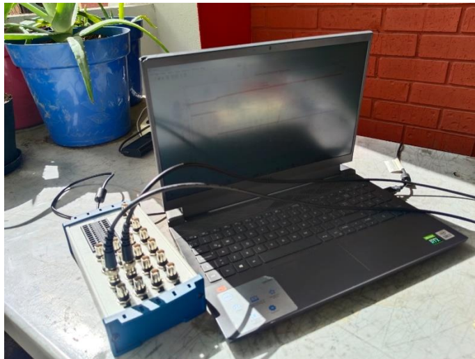
Figura 13. DAC Adquisidor de señales
