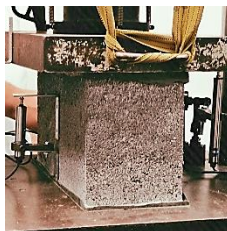
Figura 15. Ensayo de resistencia a compresión en bloques huecos de concreto
