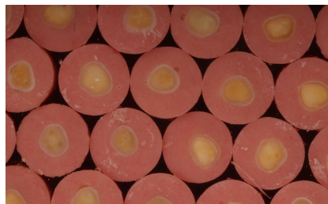
Fig. 1. Muestras de dentina cortada en cilindro de resina acrílica autopolimerizable
