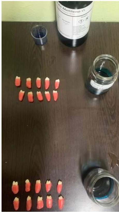
Fig.7 Sumersión en azul de metileno al 1% de los dos subgrupos para medir la microfiltración.
