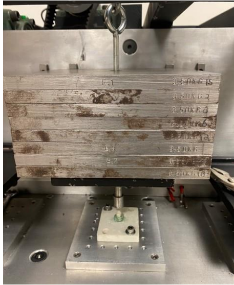
Fig.12 Subgrupo A sometida a 28 kilogramos en la máquina de esfuerzos universal.
