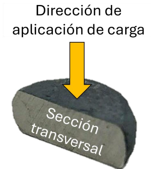
Figura 41. Plano de corte de las probetas ensayadas en compresión uniaxial (sección transversal) para caracterización microestructural.
