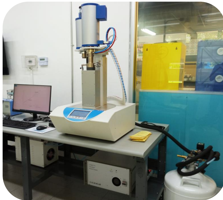
Figura 21. Dilatómetro vertical utilizado para determinar la T_{\beta t} de la aleación Ti-407.
