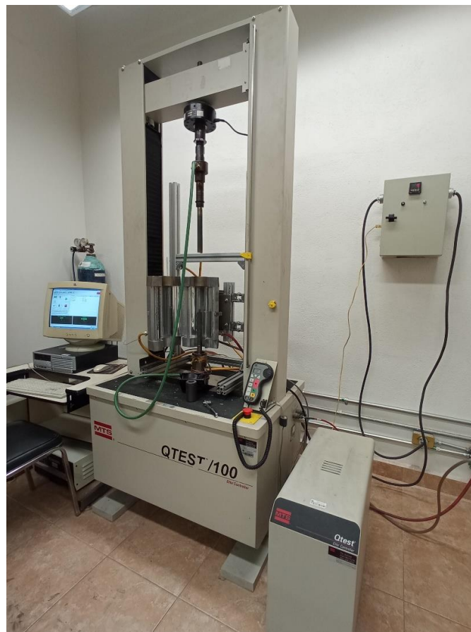
Figura 26. Máquina universal MTS modelo QTEST / 100 equipada con horno para ensayos de compresión a alta temperatura.
