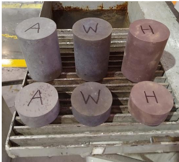
Figura 23. Cilindros de geometría “B”, tratados térmicamente a T > T_{\beta_t} y enfriados en aire (izquierda), agua (centro) y horno (derecha), y segmentos tratados de la misma manera para su subsecuente caracterización mecánica y microestructural.
