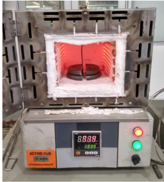
Figura 28. Distribución de muestras de geometría B en la mufla de tratamiento térmico durante el ciclo de solubilizado a 835°C.
