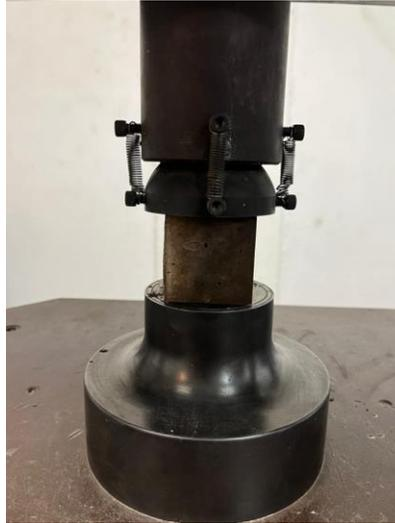
Figura 10. Cubo en prueba de resistencia a la compresión.
