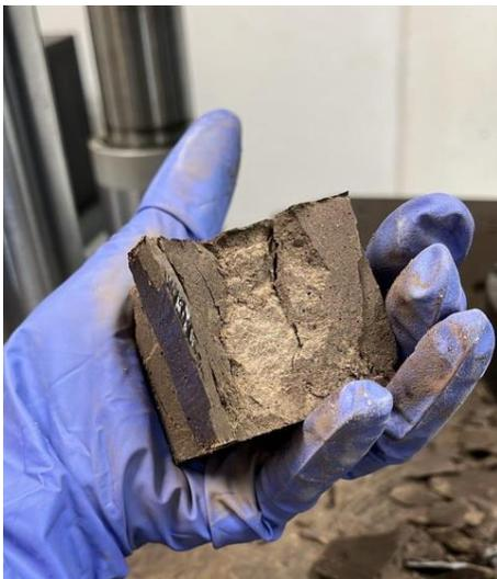
**Figura 24. Espécimen después de la prueba de resistencia a compresión**
