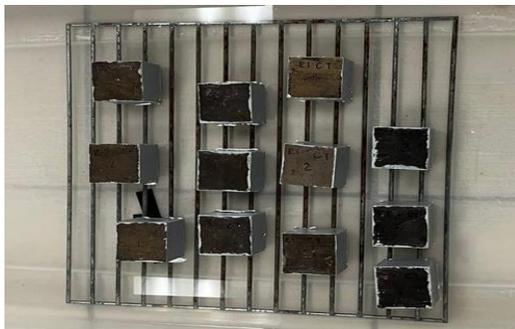
**Figura 26. Especímenes en prueba a sortividad**
