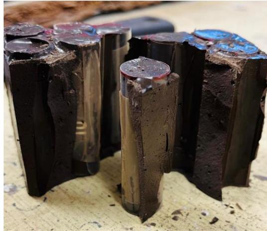
**Figura 27. Mezclas vaciadas en moldes para pruebas microestructurales.**
