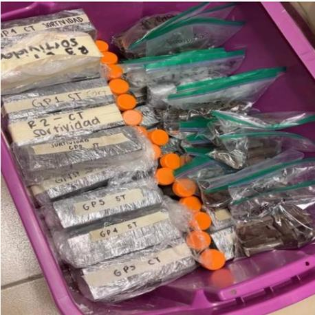
**Figura 61. Parte del almacenamiento de especímenes para pruebas de sortividad y de microestructura.**
