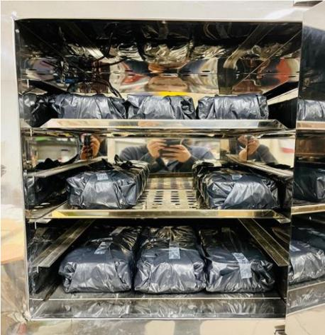
**Figura 60. Especímenes con curado inicial en horno a 60°C por 24 hrs.**
