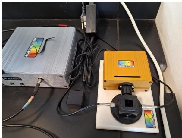
**Figura 11.** Espectrofotómetro de fotoluminiscencia (PL) marca StellarNet, modelo Fluor-System.
