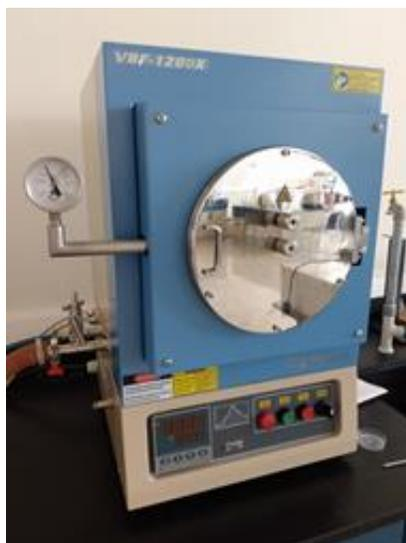
**Figura 15.** Horno de vacío marca MTI Corporation, modelo VBF-1200X.
