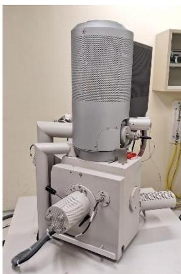
**Figura 17.** Microscopio SEM marca FEI, modelo Nova NanoSEM 200.
