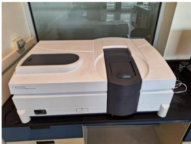
**Figura 10.** Espectrómetro de absorción óptica UV-Vis-NIR, marca Agilent, modelo Cary 5000.
