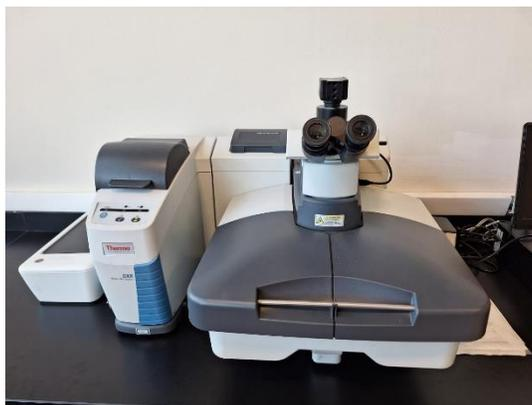
**Figura 16.** Microscopio Raman marca ThermoFisher Scientific, modelo DXR.
