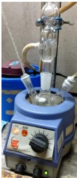
**Figura 7.** Arreglo experimental para síntesis de PbS QDs
