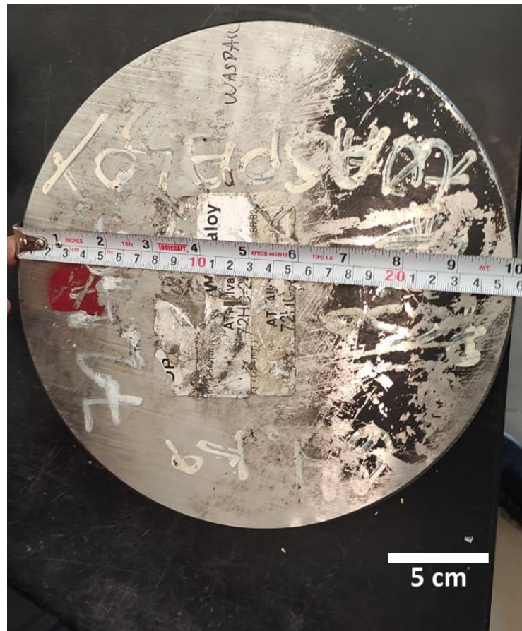
Figura 19. Disco de donde se obtuvieron los prismas rectangulares de Waspaloy.
