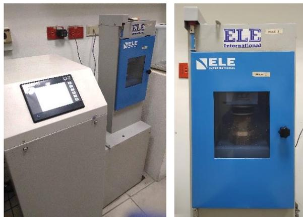
**Ilustración III.13.** Equipo de prueba a compresión ELE. Ubicado en laboratorio de materiales avanzados, UANL
