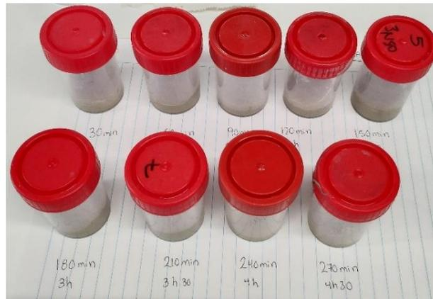
**Ilustración III.11.** Porciones de pasta híbrida sulfoaluminosa para ensayo de curva de flujo a diferentes intervalos de tiempo
