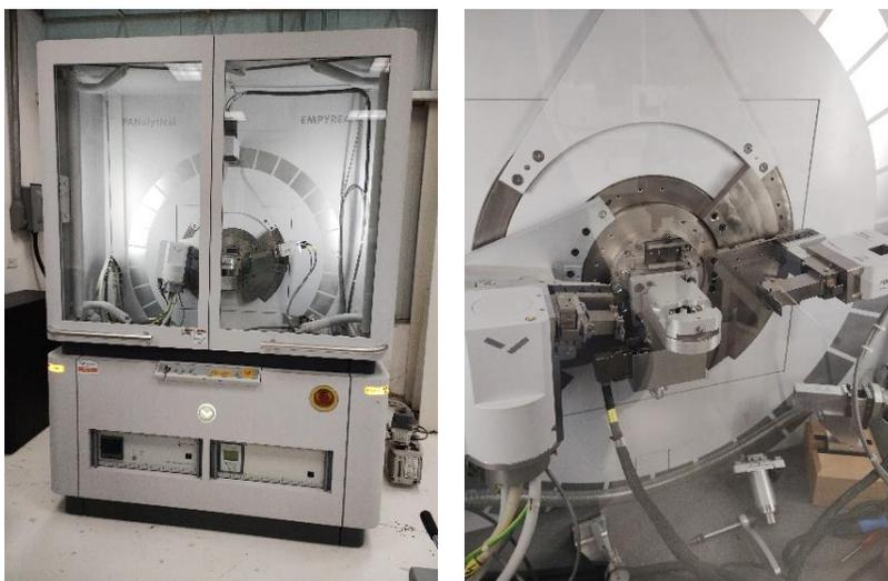
**Ilustración III.3.** Difractorómetro de Rayos X. Ubicado en el CIHA, UANL
