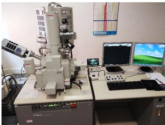
**Ilustración III.19.** Microscopio Electrónico de Barrido. Ubicado en el CENIM, CSIC
