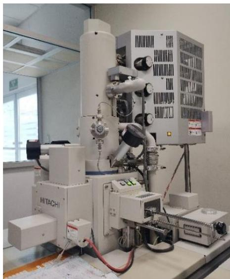
**Ilustración III.4.** Microscopio Electrónico de Barrido. Ubicado en el laboratorio de materiales avanzados, UANL
