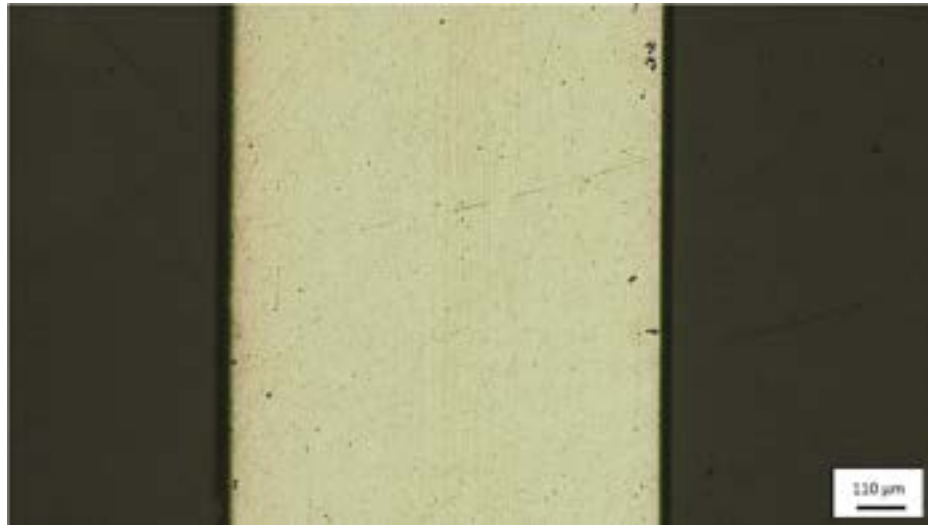
Fig. 3.3.1. Imagen de MO de la sección longitudinal de la aleación 1120 en su estado original.
