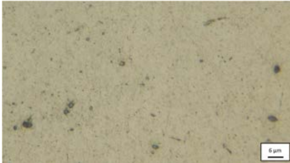
Fig. 3.3.3. Imagen de MO de la sección longitudinal de la aleación 1120 en su estado original antes del cuarto ensayo de fluencia. Escala: 6 \mu\text{m} .
