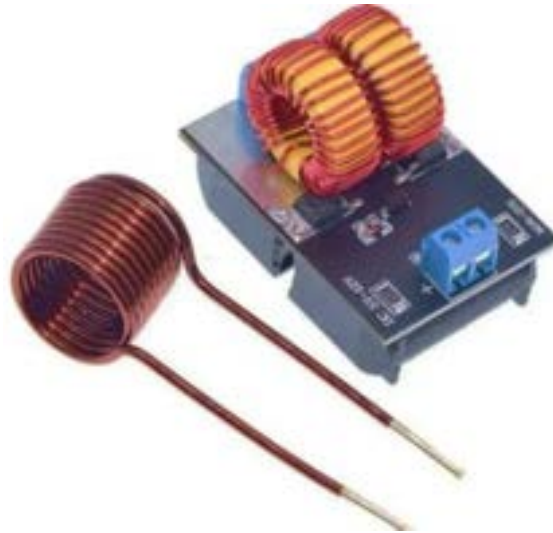
Fig. 2.2.4. Módulo calentador de inducción magnética.
