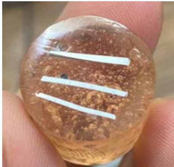
Fig. 2.4.3. Muestra de alambres de aleaciones de aluminio suspendidos en resina con acabado espejo.
