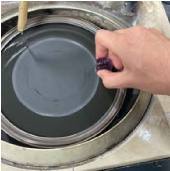
Fig. 2.4.2. Desbaste de alambres de aluminio suspendidos en la resina.
