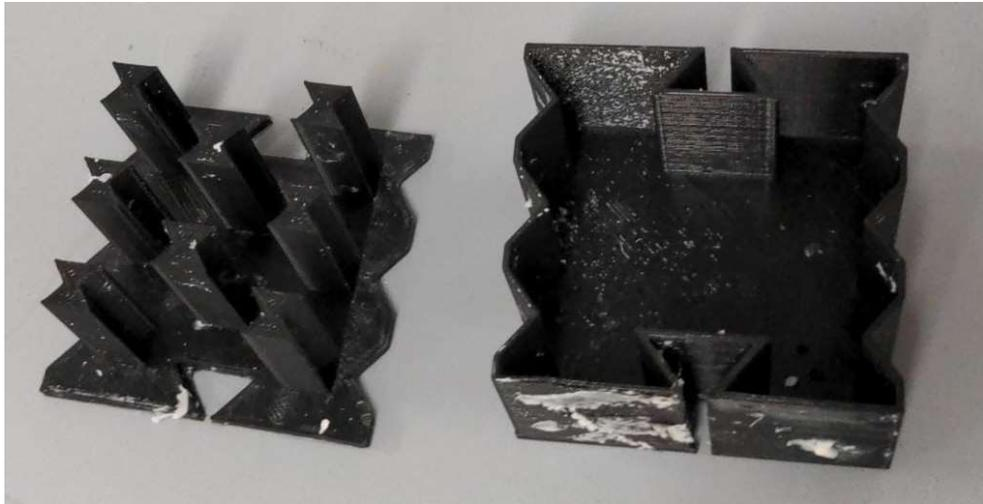
Figura 5.3. Molde para la metaestructura impreso en 3D.
