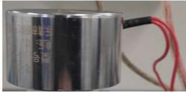
Figura 3.11: Electroimán utilizado en pruebas de respuesta en frecuencia en muestras MRE.
