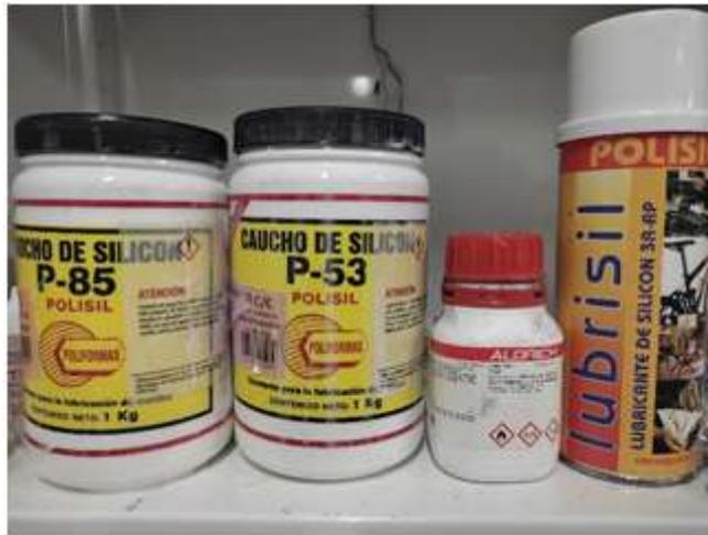
Figura 3.1: De izquierda a derecha caucho de silicón P-85 y P-53, partículas de hierro carbonilo y lubricante.
