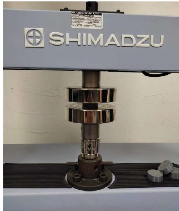
Figura 3.4: Prueba de compresión en muestras de elastómeros magnetoreológicos en máquina universal Shimadzu AGS 10KN.
