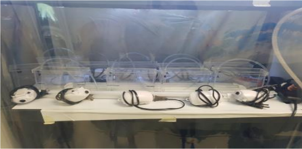
Figura 6. Sistema de remoción de nutrientes, 10 fotobiorreactores, bombas lámparas en estante asilado.
