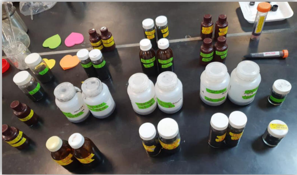
Figura 3.3 Muestras de lubricante Sigralub adicionado con nanoestructuras
