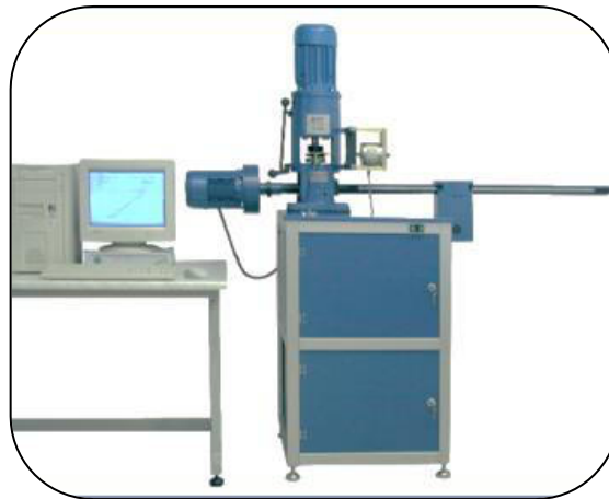
Figura 3.5 Máquina de Prueba 4 bolas T-02 UVM.
