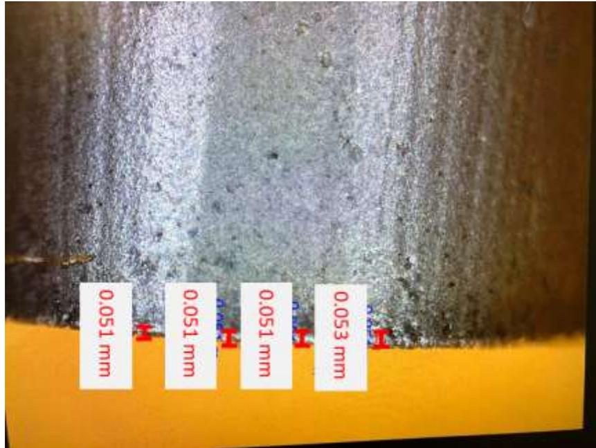
Figura 6.1.4. Desgaste presentado en cortador reafilado por proveedor Starsu en microscopio DNT 5 MP 120 x.
