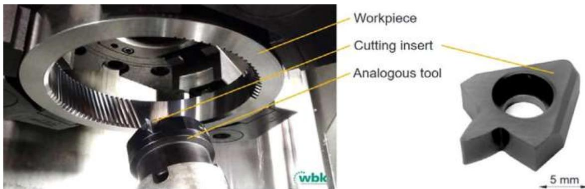
**Figura 7.1 Cortador de tipo insertos utilizado en el maquinado de un engrane con acero 31CrMoV9 (AISI 4340) templado.**
