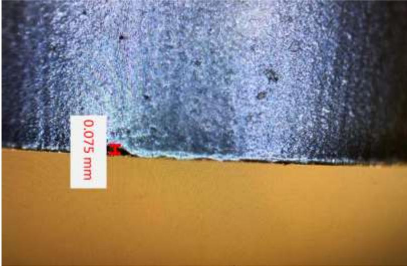
**Figura 6.1.7. Desgaste de cortador, recubrimiento Altensa, proveedor de reafilado StarSu después de 55 piezas en microscopio DNT 5 MP 120 x.**
