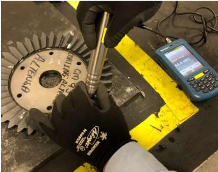
**Figura 5.3.1. Evaluación de dureza de recubrimiento Altensa con máquina SonoDur.**
