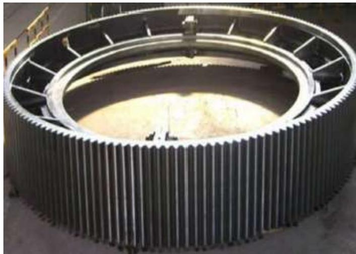
**Figura 3.5.9 Anillo de fundición en molde de arena utilizado en la industria de la minería. [19]**
