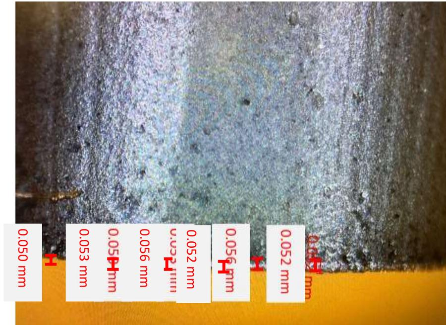
Figura 6.1.3. Desgaste presentado en cortador reafilado por proveedor Gleason en microscopio DNT 5 MP 120 x.
