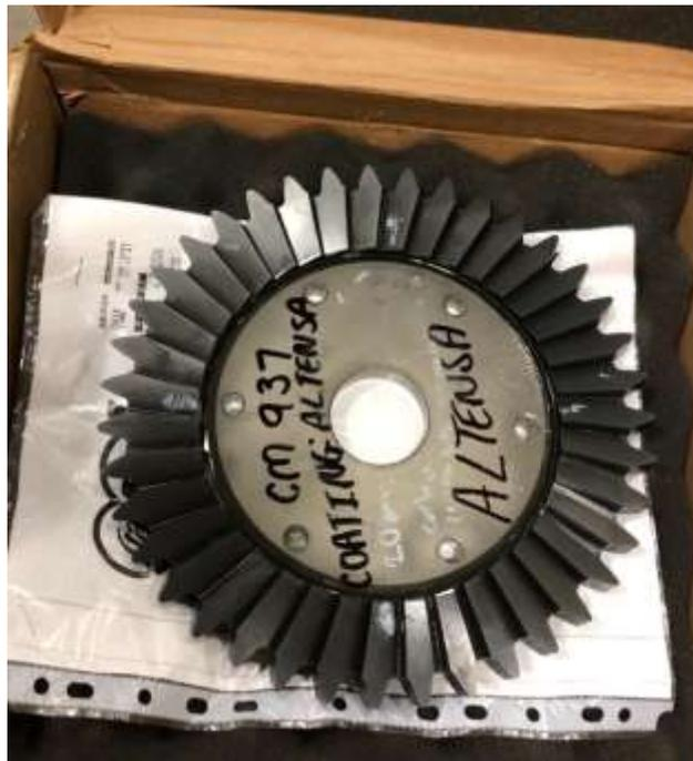
**Figura 6.2.2. Cortador utilizado en la segunda fase de la experimentación (14559102).**
