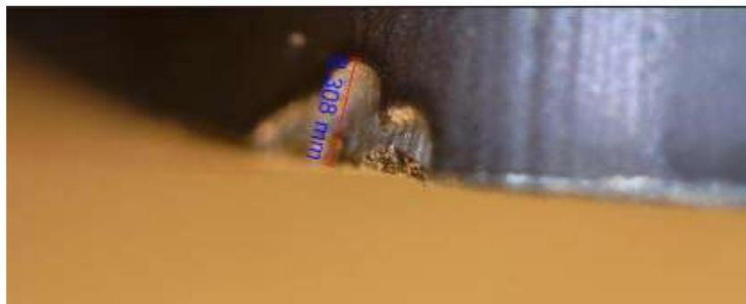
**Figura 4.5 Daño de un cortador skiving de 0.308 mm evaluado con un comparador óptico digital.**
