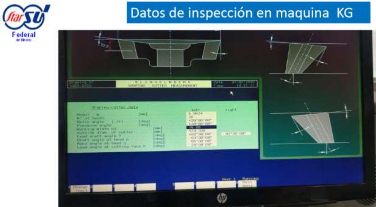
**Figura 6.2.1. Condiciones de reafilado en máquina rectificadora de cortadores Klingelberg, proveedor Starsu para el cortador 1455-9102.**
