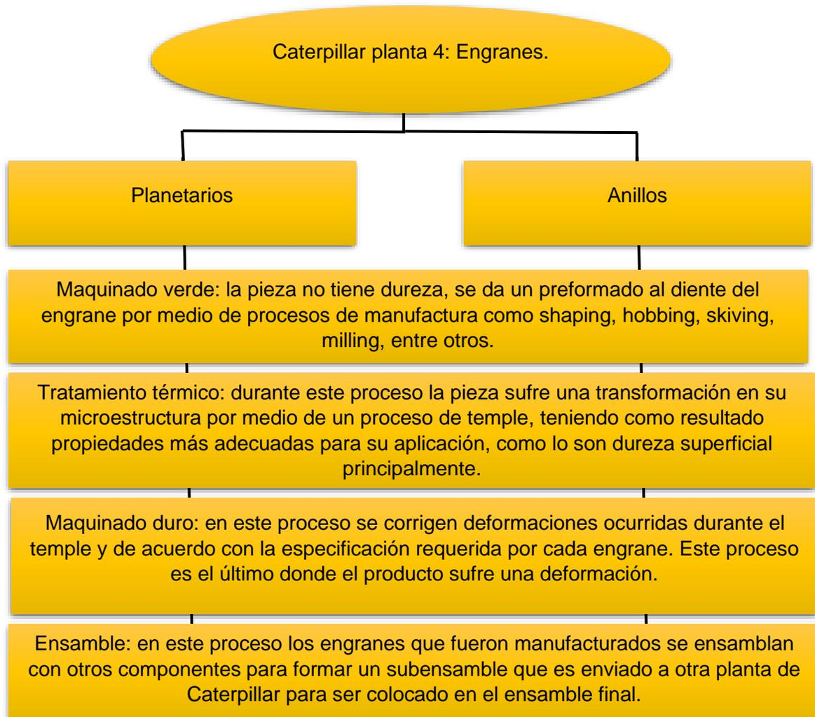
**Figura 1.1. – Diagrama de flujo de procesos (cadenas de valor) de Caterpillar planta 4.**
