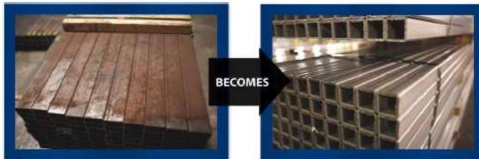
**Figura 4.6 Material antes (izquierda) y después (derecha) de un proceso de decapado. [22]**
