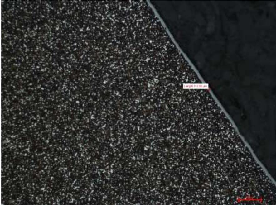
**Figura 5.2.2 Fotografía de diente de cortador lateral con un grosor de recubrimiento de 2.96 micras en el recubrimiento Alcrona.**
