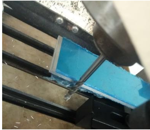
Figura 27. Fotografía de fresado de placa de aluminio
