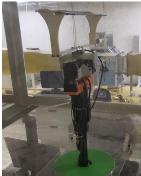
Figura 32. Perfil biplano de ala delta invertida durante prueba dentro del túnel de viento.
