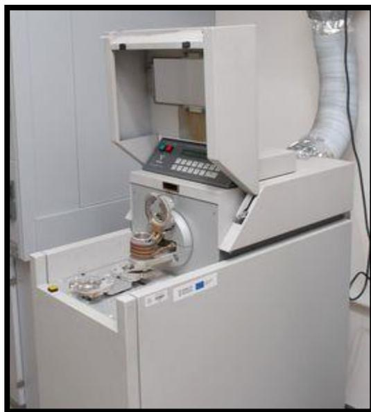
*Figura 19. Espectrómetro secuencial de rayos-X.*
