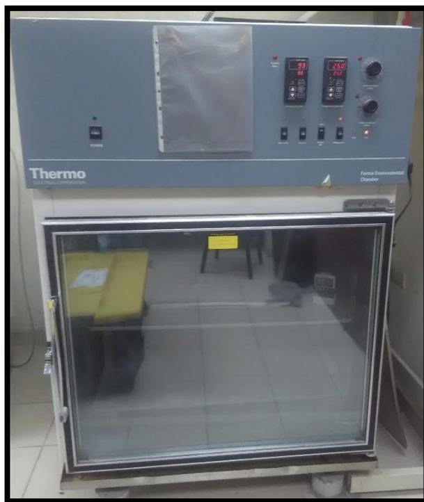
*Figura 23. Cámara de humedad a utilizar para realizar la prueba de hidratación.*
