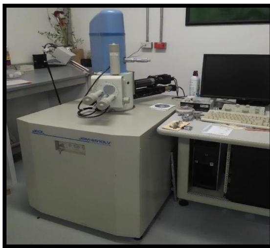
*Figura 18. Equipo de microscopía electrónica de barrido.*
