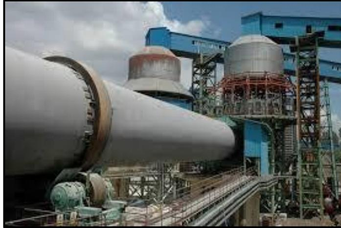
*Figura 2. Hornos rotatorios de cemento.*
