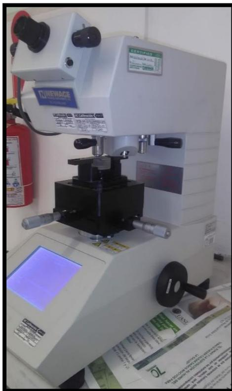
*Figura 25. Microindentador a utilizar para medir microdureza Vickers.*
