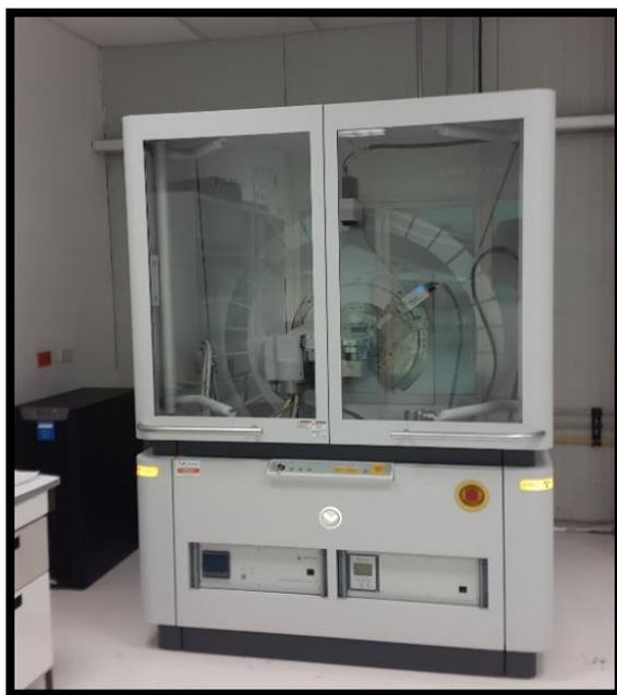
*Figura 17. Equipo de difracción de rayos-X.*
