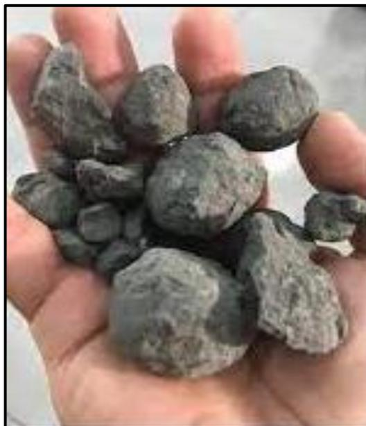
*Figura 3. Nódulos de clinker de cemento.*
