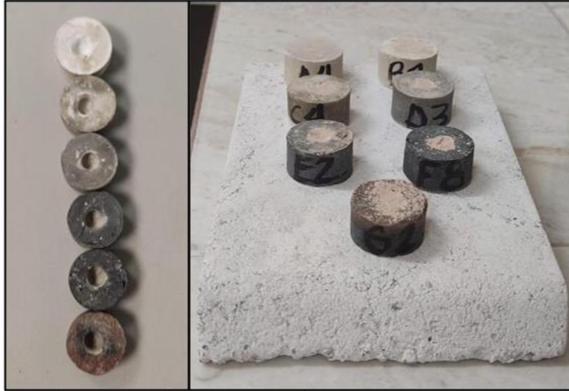
*Figura 27. Probetas refractarias perforadas con harina de clínker de cemento en su interior.*
