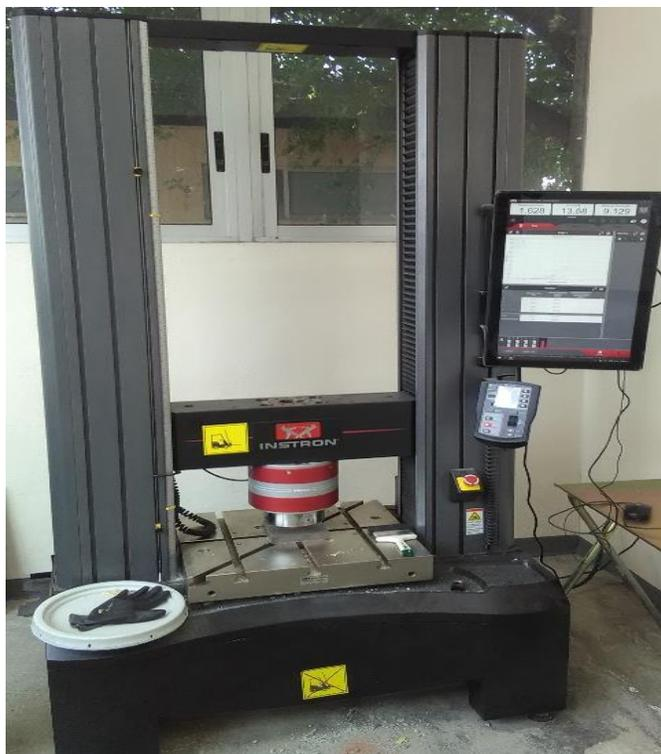
*Figura 24. Prensa utilizada para obtener los valores de CCS.*
