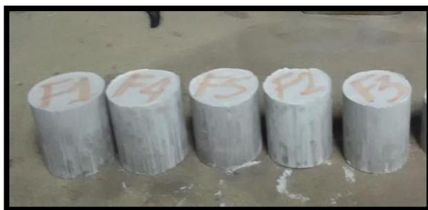
*Figura 33. Probetas refractarias cilíndricas obtenidas después del prensado uniaxial en seco.*
