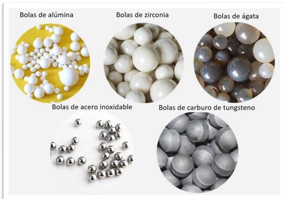
*Figura 16. Bolas para molienda mecánica de distintas composiciones químicas.*
