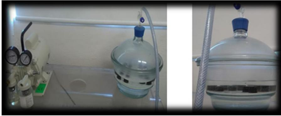
Figura 21. Cámara de vacío a utilizar para la obtención de porosidad y densidad.
