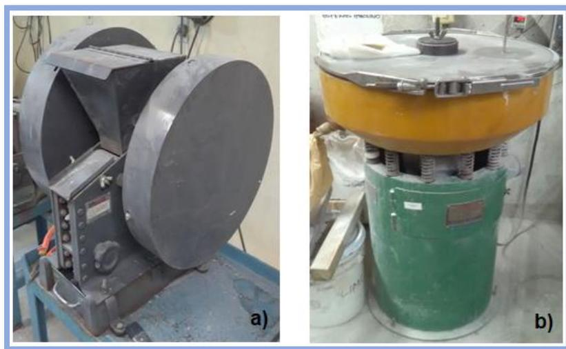
*Figura 28. a) Trituradora de mandíbulas, b) Molino de bolas.*
