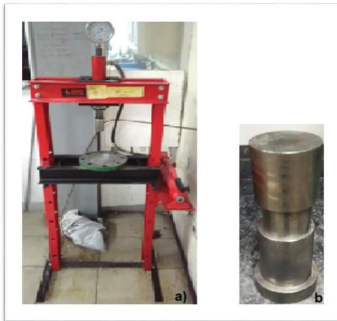
*Figura 32. a) Prensa Dogo Tulls utilizada, b) Molde utilizado para conformar probetas cilíndricas.*
