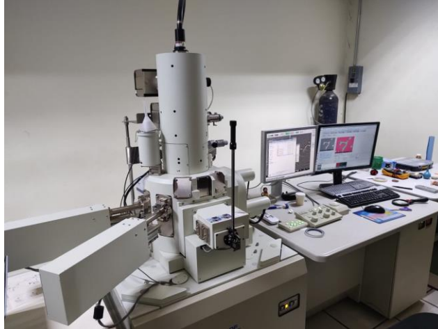
Figura 23. Equipo SEM con módulo de difracción de electrones retrodispersados para obtener la información de textura del material.
