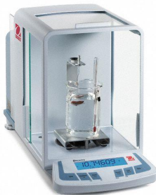
Figura 24. Kit de determinación de densidad adherido a la balanza Ohaus AV53X.
