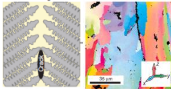
Figura 14. Crecimiento dendrítico se sustituyen por grietas en la microestructura equiaxada (Kaufmann et al) [69].
