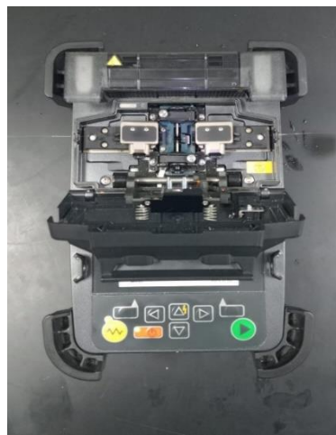
Figura 16 Fotografía tomada desde arriba de la empalmadora de fibra s178 A versión 2.
