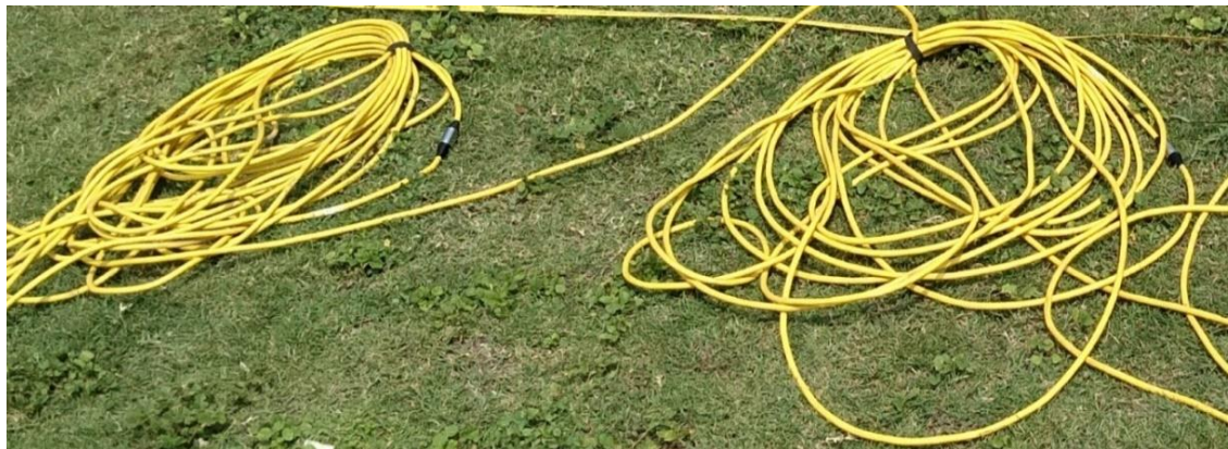
Figura 32. Cables multi-electrodo AGI.
