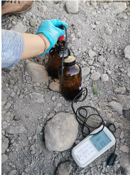
Figura 14. Determinación de pH en muestras de agua empleando un potenciómetro marca HORIBA-LAQUA Act.
