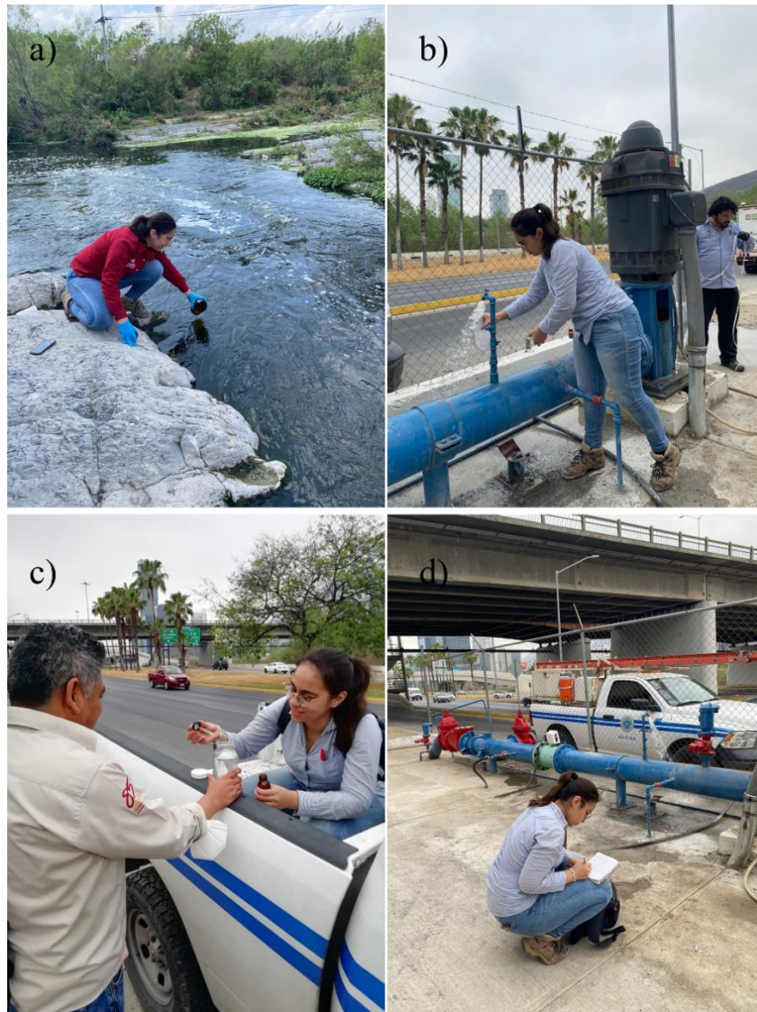
Figura 13. a) Toma de muestra en área de flujo turbulento, b) Toma de muestra de agua subterránea de acuerdo a su respectiva norma, c) Adición de ácido en la muestra y d) Bitácora de identificación de la muestra.
