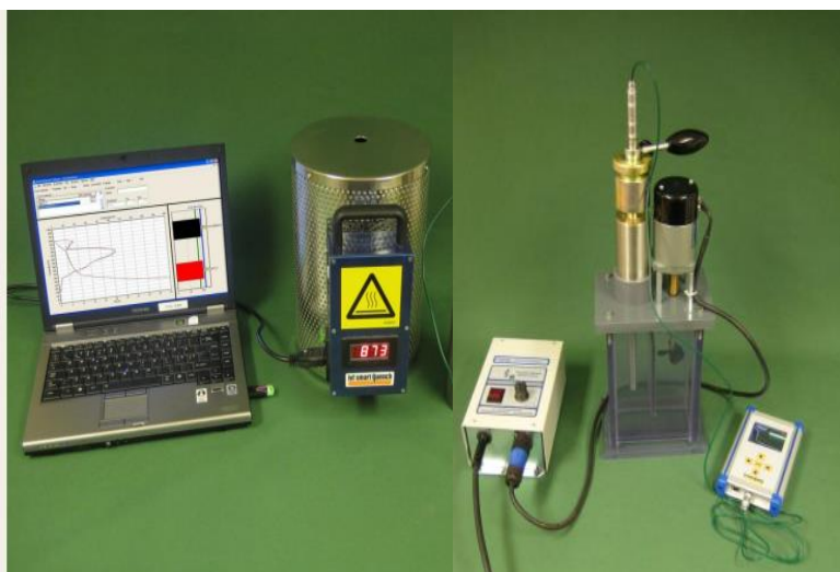
Figura 6. Equipo de IVF SmartQuench con tina de agitación
