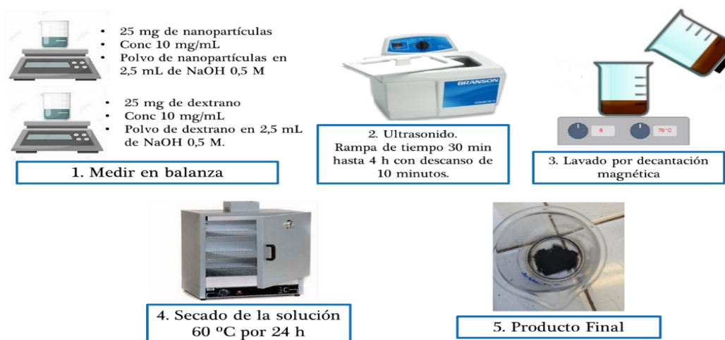
Figura 37. Diagrama esquemático del proceso de recubrimiento de los nanocompositos obtenidos.
