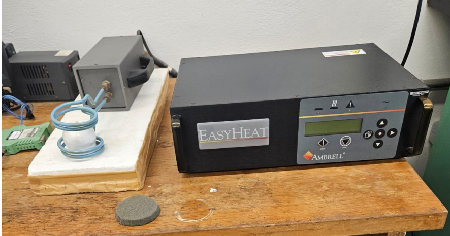
Figura 44. Equipo de inducción magnética.
