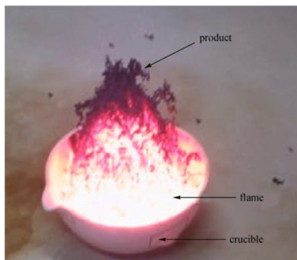
Figura 15. Reacción de autocombustión [62].
