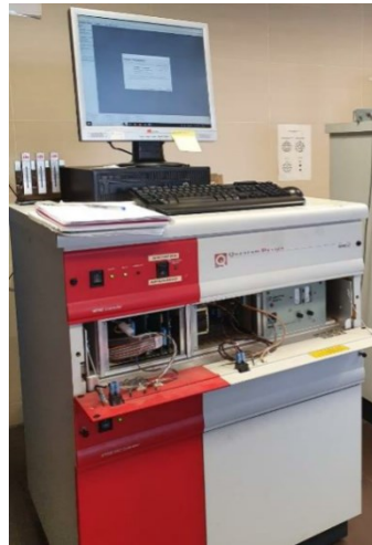
Figura 43. Equipo SQUID modelo Quantum Design MPMS.
