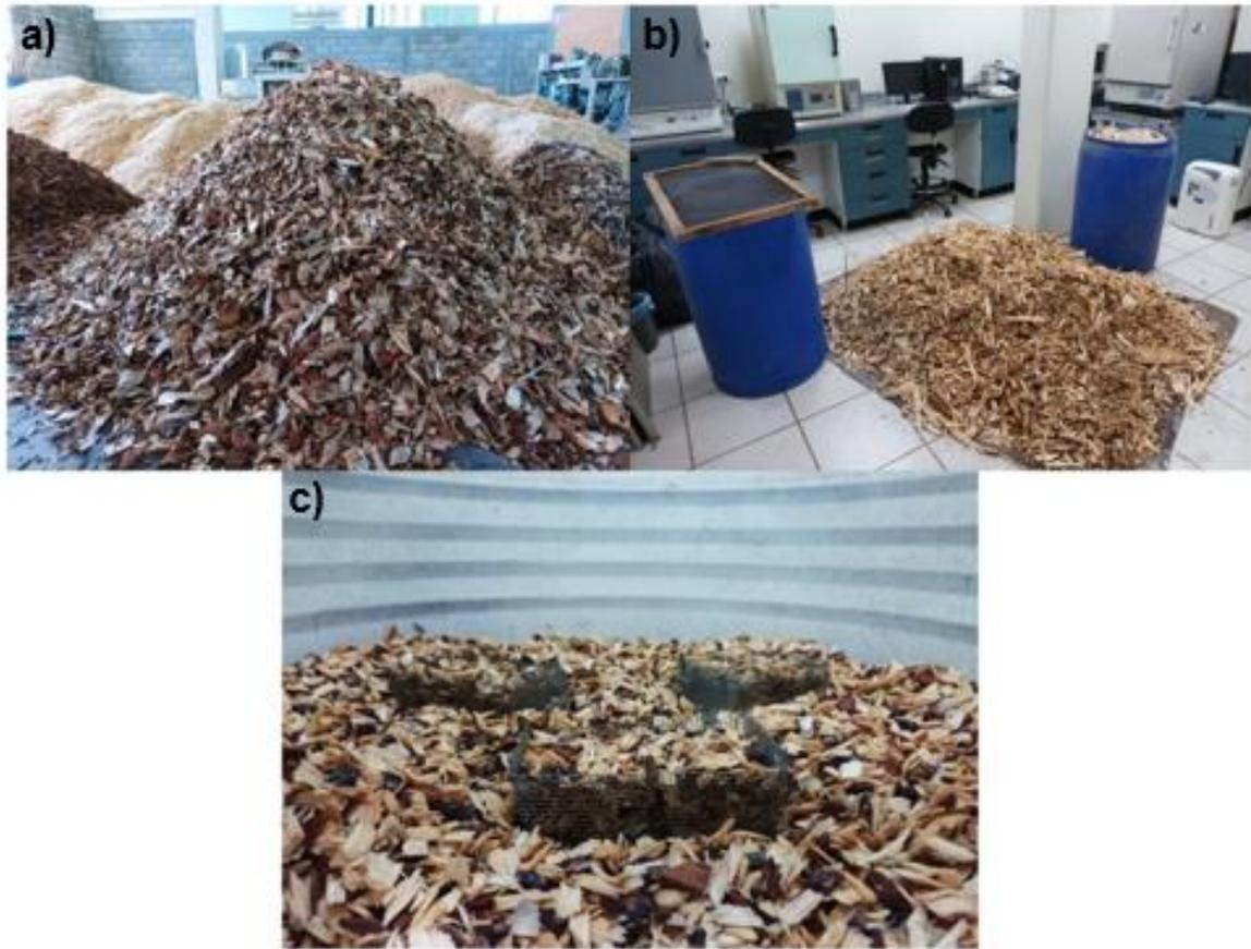
Figura 3. 1. Astillas de pino utilizadas en los tratamientos de secado: a) Astillas secas, b) Astillas húmedas en acondicionamiento, c) Astillas en secador.
