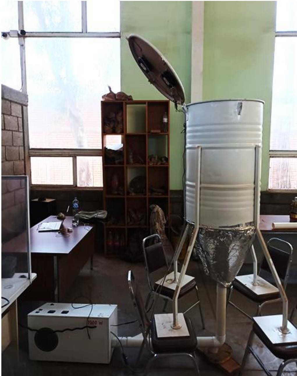
Figura 2. 1. Secador experimental de biomasa desarrollado y fabricado para la realización de los tratamientos de secado y la medición de pérdida de humedad en las astillas de madera de pino.
