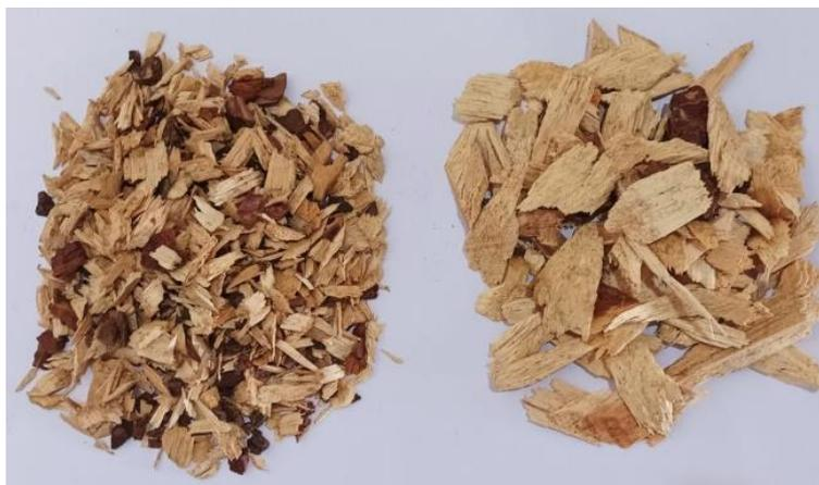
Figura 4. 1. Astillas de madera de pino, a la izquierda se muestran las partículas pequeñas (3.15-16.0 mm), y a la derecha las partículas grandes (16.1-45.0 mm).
