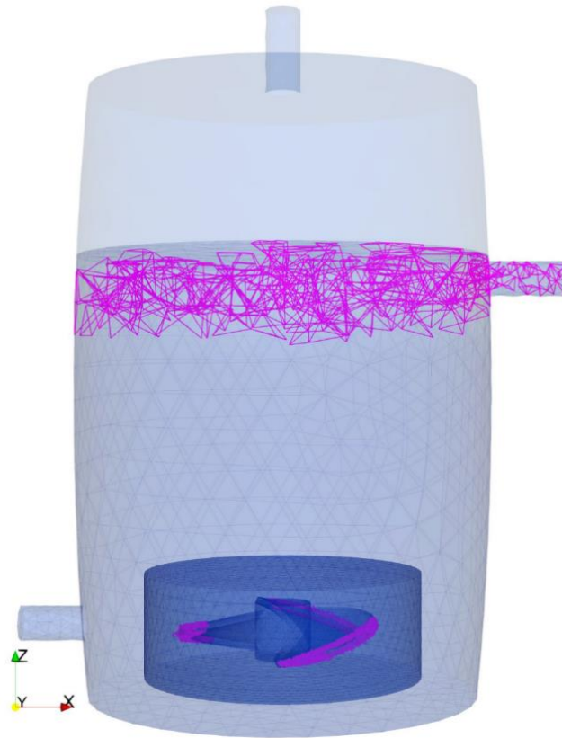
Figura 17. Celdas con velocidad entre 0.8 y 1 \text{ m s}^{-1} en el tiempo 150 s.
