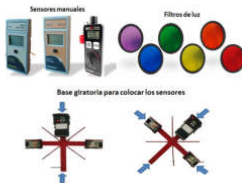
Figura 12. Sensores manuales, filtros selectivos y base para capturar la radiación incidente y reflejante
