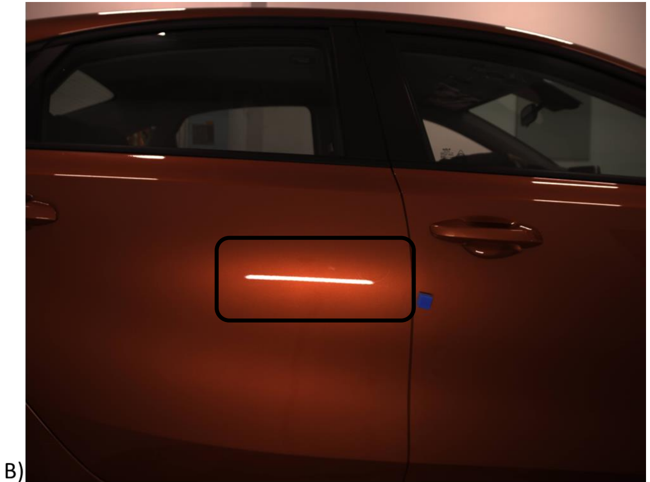
Figura 30. Prueba de reflejo de luz. A) Prueba realizada donde no se refleja la luz (Lampara sin funcionar), B) Prueba donde si se refleja la luz (Lampara funcionando) (Elaboración propia).
