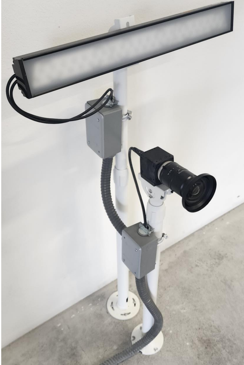
Figura 24. Primer posicionamiento de cámara y lampara led (Elaboración propia).
