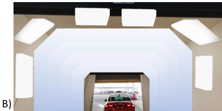
Figura 38.A) Primera propuesta para la creación de una segunda pared y B) Segunda propuesta para la colocación de módulos de lámparas y una segunda pared para lograr una uniformidad en la iluminación de las imágenes (Elaboración propia).
