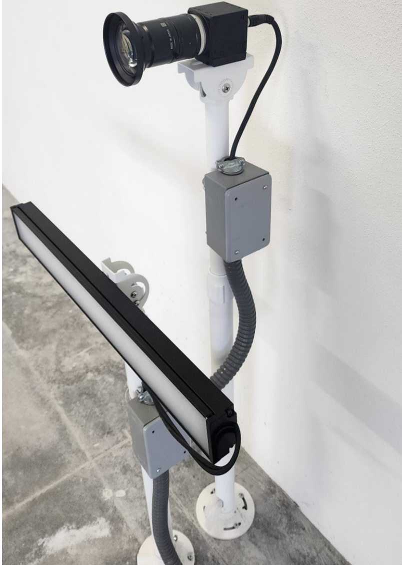
Figura 27. Segundo posicionamiento de cámara y lampara led (Elaboración propia).
