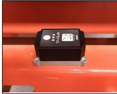
Figura 4.4 Sensor montado en viga estudiada.
