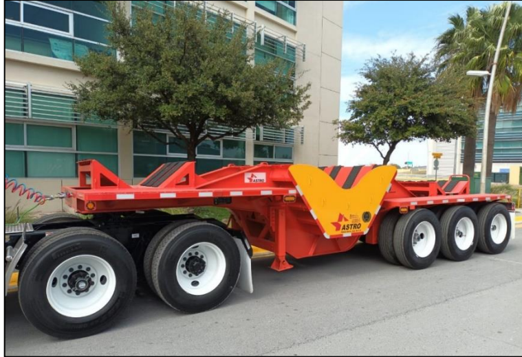
Figura 2.1 Plataforma transportadora de rollos de acero Big Coil.
