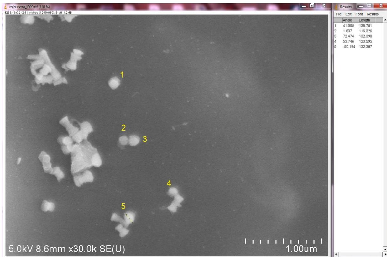
Fig. 7 Ejemplo de mediciones de NPCo utilizando el software ImageJ
