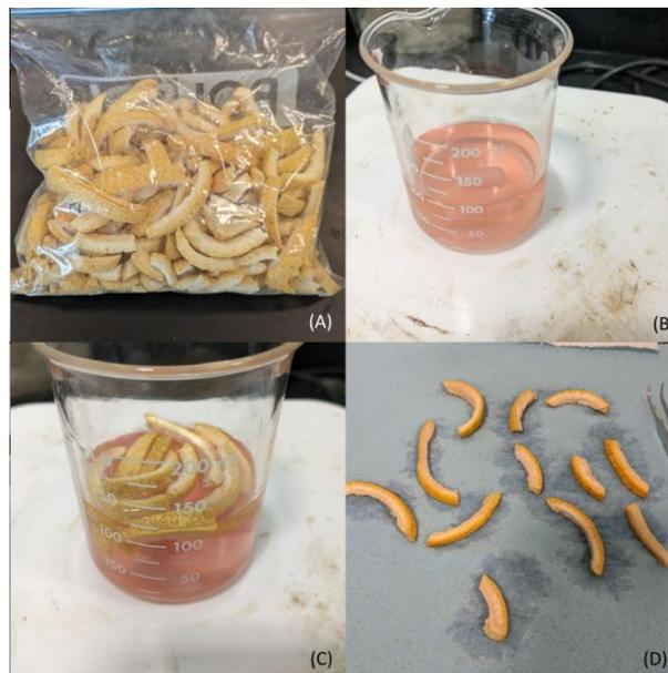
Fig. 4: Demuestra los pasos para la preparación de las muestras antes de cargarlas en el horno. (A) Cáscara de naranja como materia prima. (B) Solución de nitrato de cobalto. (C) Rehidratación de la cáscara de naranja. (D) Cáscaras se secan para remover exceso de solución.
