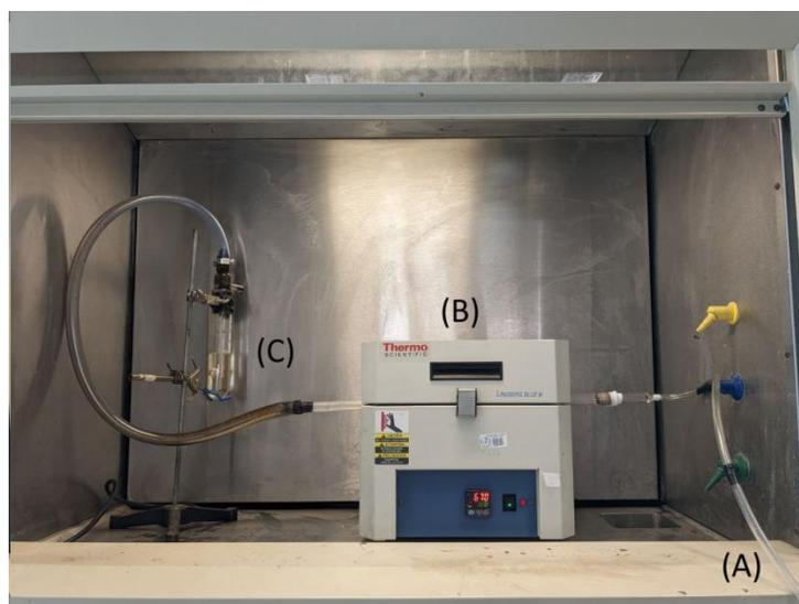
Fig. 5 Sistema de horno tubular utilizado en la síntesis. (A) Tubo que introduce el gas argón. (B) Horno tubular. (C) Trampa de gas.
