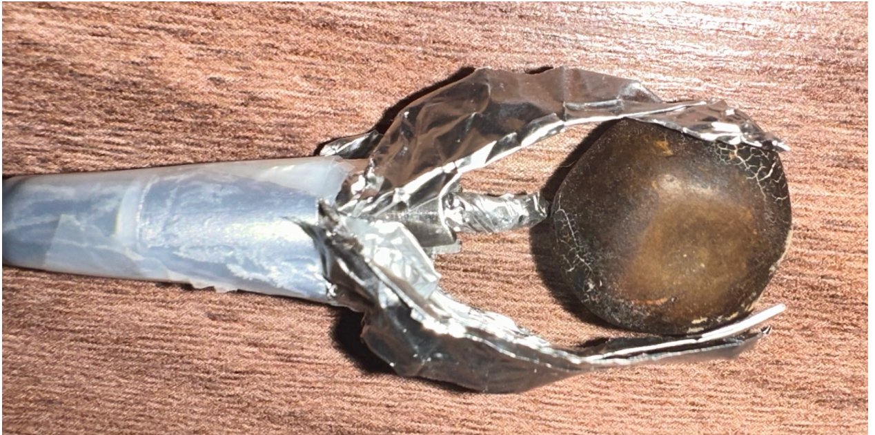
Fig 9. Prototipo de 2 garras incluidas en la punta para sostener el lito, en medio de ellas vemos la fresa que se utilizará para triturar el lito.
