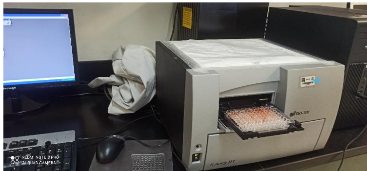
Fig. 9. Lector de microplacas utilizado en el laboratorio de Química Central Sisal UNAM en Yucatán.
